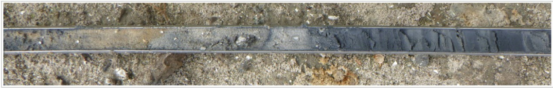
Figuur 4: Marknesse, Vollenhoverweg: Het schelprijke Urk-zand (links) dat op het centrale- en het zuidoostelijke deel van het plangebied onder de bouwvoor is aangetroffen met daaronder (rechts) het hieronder gelegen pakket door kleilaagjes onderbroken zand.
