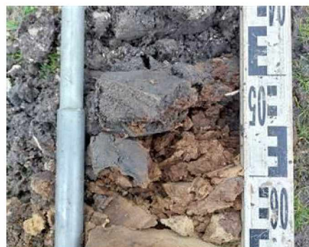
Afbeelding 9: op enkele plekken is de verdichting dermate sterk, dat de grond blauw is en een zwavelachtige geur afgeeft
