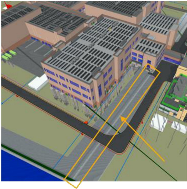
Figuur 19. Civiel 3D-model met de ligging van de waterkering (geel omlijnd).
