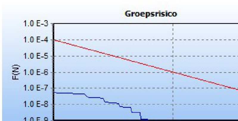
5.5 Figuur 5.5 FN curve voor 10195_leiding-W-535-18-deel-1 van N.V. Nederlandse Gasunie voor de kilometer tussen stationing 0.00 en stationing 700.00
