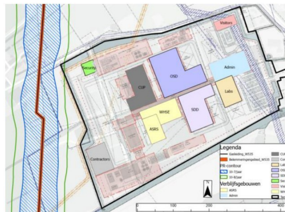
figuur 9: een klein deel van het terrein ligt binnen de 10^{-8} /jaar PR-contour van buisleiding W-535.
