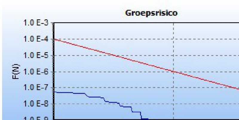
5.5 Figuur 5.5 FN curve voor 10195_leiding-W-535-18-deel-1 van N.V. Nederlandse Gasunie voor de kilometer tussen stationing 0.00 en stationing 700.00
