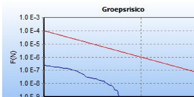
5.2 Figuur 5.2 FN curve voor 10195_leiding-W-535-01-deel-1 van N.V. Nederlandse Gasunie voor de kilometer tussen stationing 3740.00 en stationing 4740.00
