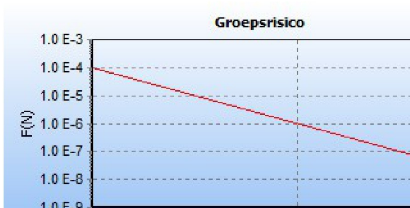
5.5 Figuur 5.5 FN curve voor 10195_leiding-W-535-18-deel-1 van N.V. Nederlandse Gasunie voor de kilometer tussen stationing 0.00 en stationing 700.00
