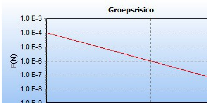
5.4 Figuur 5.4 FN curve voor 10195_leiding-W-535-13-deel-1 van N.V. Nederlandse Gasunie voor de kilometer tussen stationing 0.00 en stationing 1000.00
