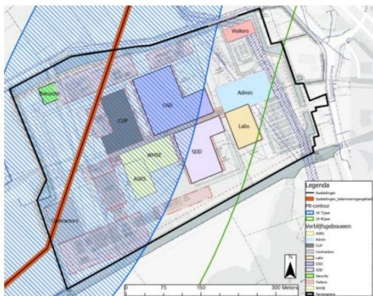
figuur 8: de westelijke helft van het terrein ligt binnen de 10^{-7} /jaar PR-contour van buisleiding A-560.
