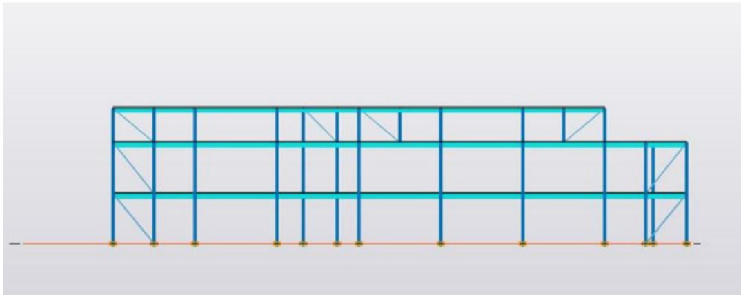
Figuur 21: Karakteristieke doorsnede Lab gebouw
