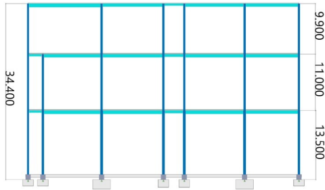
Figuur 12: Karakteristieke doorsnede SDD gebouw
