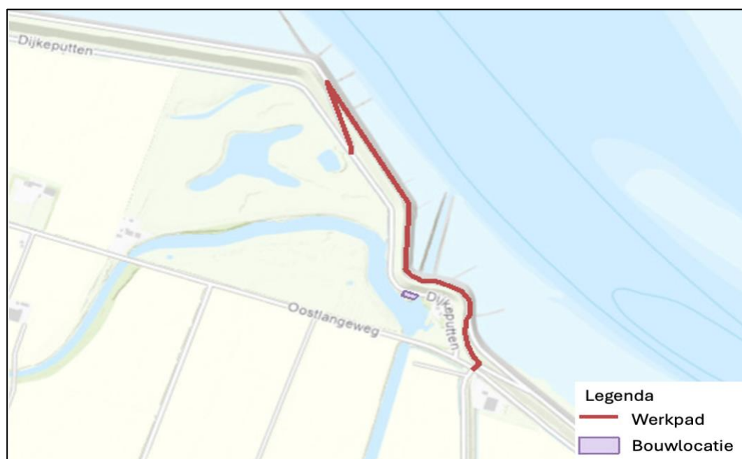
Figuur 2.1. Overzicht van het plangebied met het werkpad van verkeer over de dijk (rode lijn) en de uitwateringssluis waar een bedieningshuis en trafohuisje gerealiseerd worden (paarse vlak).
