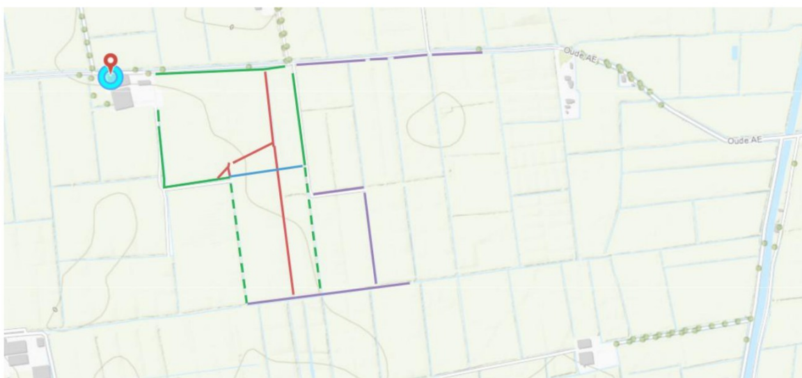
Figuur 1: Locatie van activiteiten. De rode lijn geeft de uitgevoerde demping weer. De groene lijnen geven de reeds uitgevoerde verbredingen van de oppervlaktewaterlichamen weer. De paarse lijnen geven de nog uit te voeren verbredingen van de oppervlaktewaterlichamen weer. In het blauw weergegeven de reeds gegraven watergang uit omgevingsvergunning met kenmerk Z/23/0064666.
