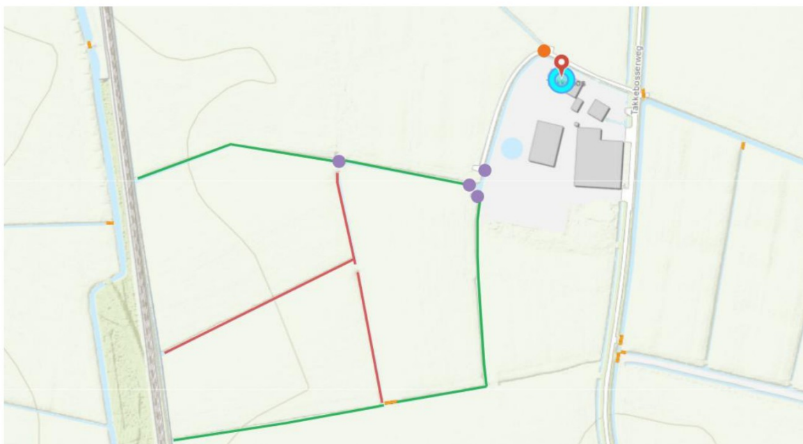
Figuur 1: Locatie van activiteiten. De rode lijnen geven de te dempen oppervlaktewaterlichamen weer. De groene lijnen geven de te verbreden oppervlaktewaterlichamen weer. De paarse stippen geven de locaties van de te liggen dammen weer, welke voorzien, dan wel voorzien dienen te worden, van duikers. De oranje stip geeft een te liggen duiker weer.
