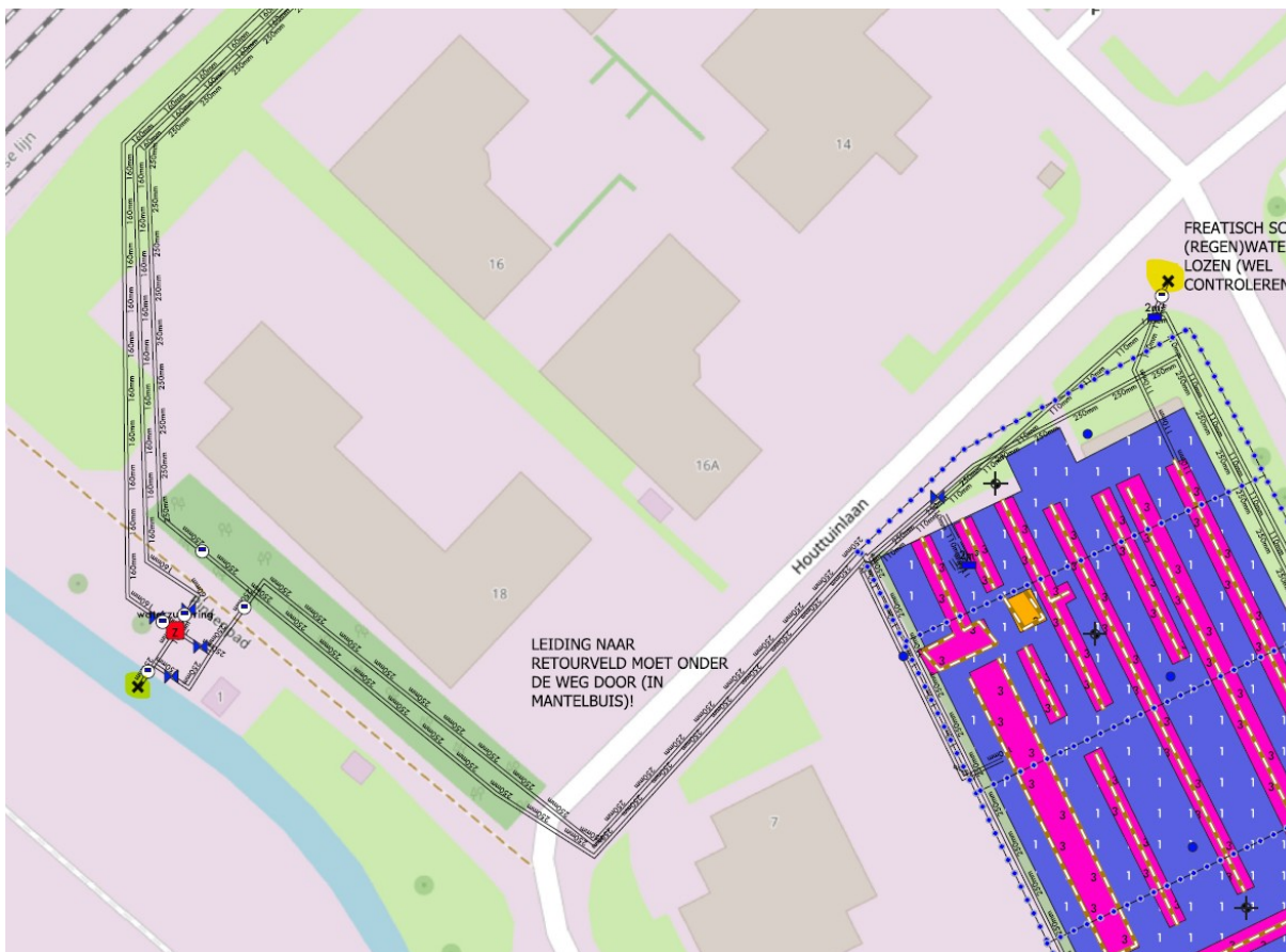
Figuur 5: Lozingspunt (bij kruis rechtsboven) van drainagewater op hemelwaterriool
