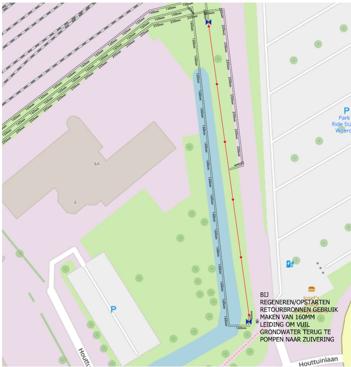
Figuur 5: Retourveld (rode lijn met 6 bronnen) met aanvoer- (250 mm) en afvoerleidingen (2 x 160 mm)
