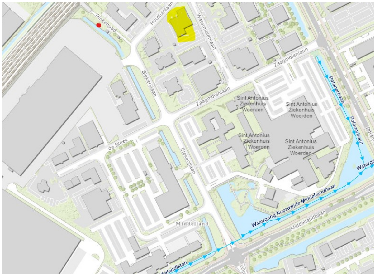
Figuur 3: lozingspunt (rode stip) op tertiaire watergang langs Pinkenpad en het regionale watersysteem
