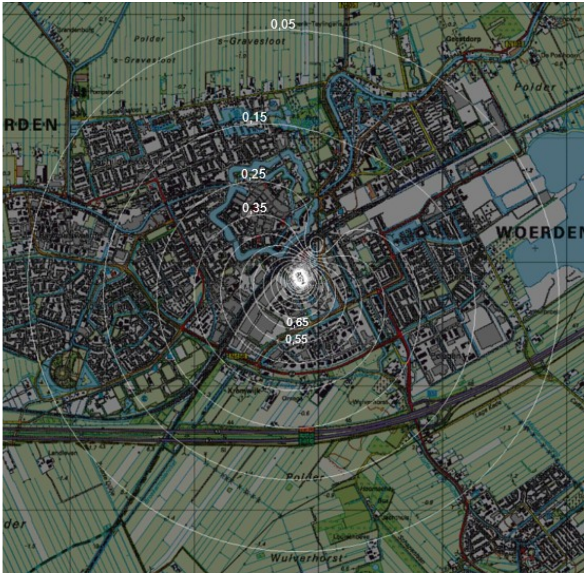
Figuur 1: Verlagsingscontouren en contouren retourveld stijghoogte in 1e WVP bij GHS
