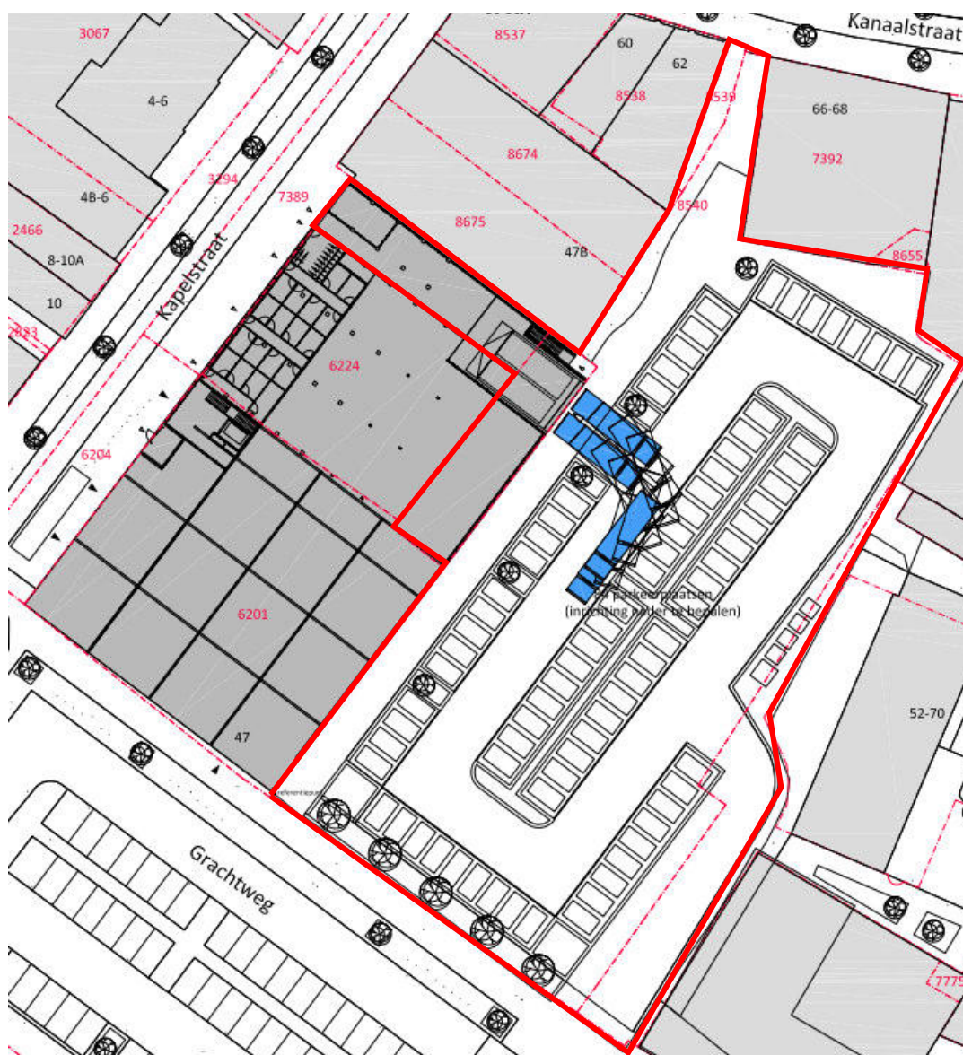
Figuur 2: Tekening van de nieuwe situatie aangeleverd door de opdrachtgever. In de panden aan de linkerkant van de tekening (met nummers 6201 en 6224) vinden alleen bovengrondse werkzaamheden plaats en horen daarom niet bij het plangebied (rode kader).
