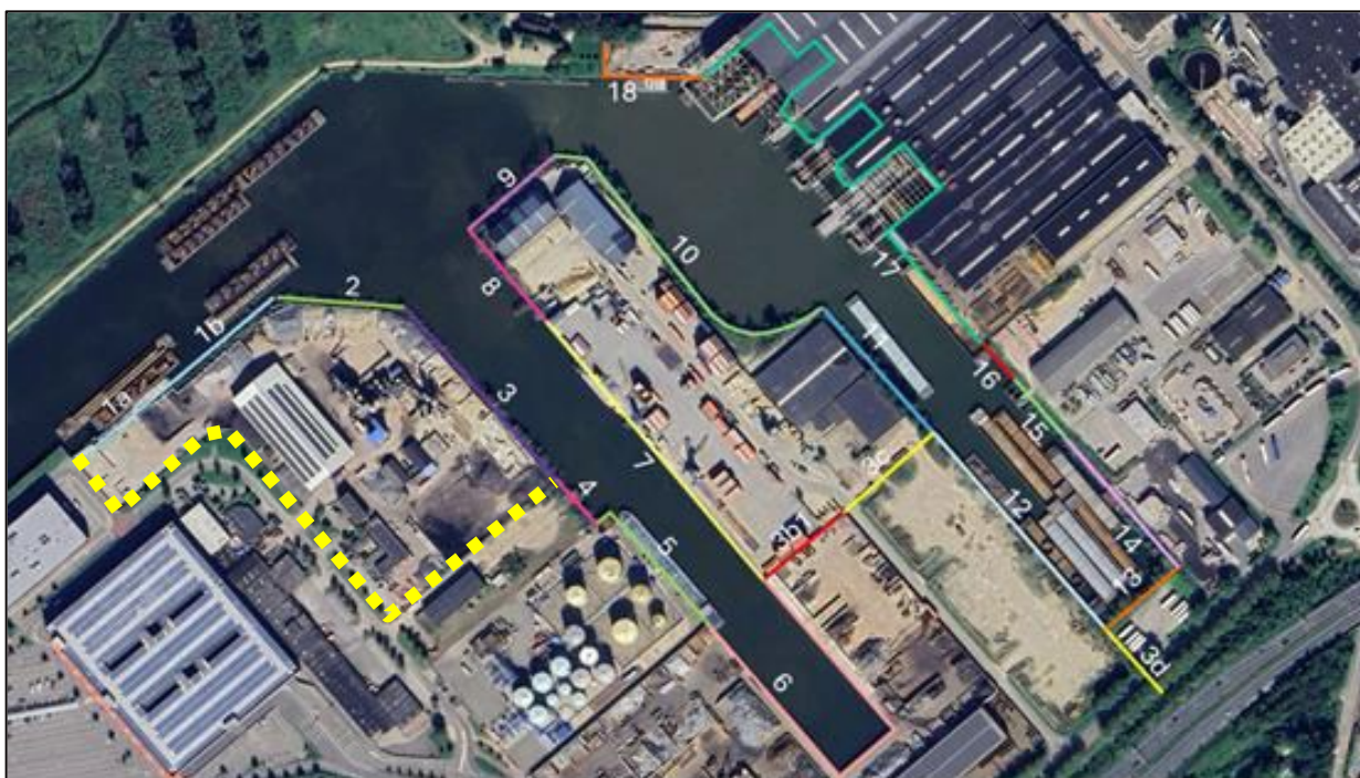
Figuur 2 Detailbeeld van de kademuren in de Willem-Alexanderhaven waar de werkzaamheden beoogd zijn. De kade is ingedeeld in trajecten van 1 t/m 18, hier gelden verschillende opgaven en benodigde werkzaamheden. Uitgangspunt is dat overal op dit kadetraject werkzaamheden in en om het water kunnen plaatsvinden. Ter hoogte van traject 1 t/m 3 wordt de bestaande primaire kering (gele stippellijn) verlegd naar de positie van traject 1 t/m 3.
