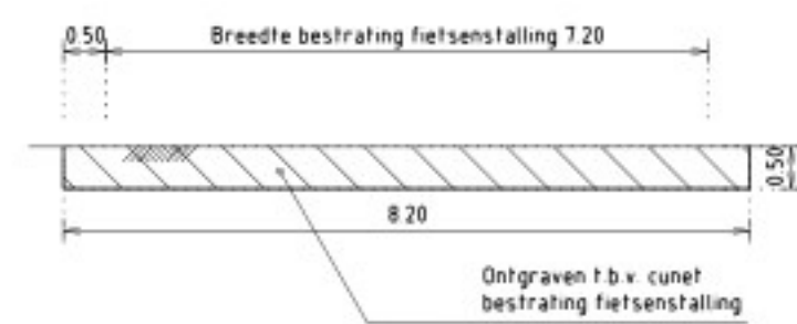
PROFIEL ONTGRAVING BESTRATING FIETSENSTALLING Schaal 1:100
