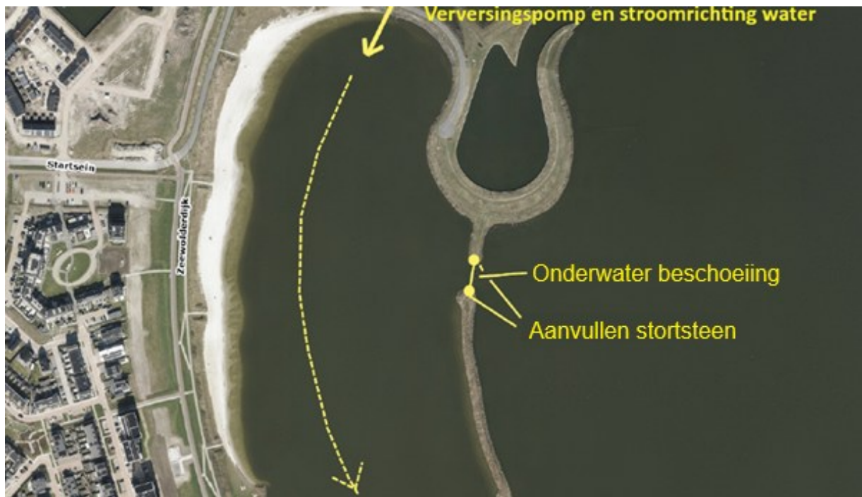
Figuur 1: Luchtfoto van 'het Landerstrand', met aanduidingen voor de verversingspomp, de onderwaterbeschoeiing en het aanvullen met stortstenen.
