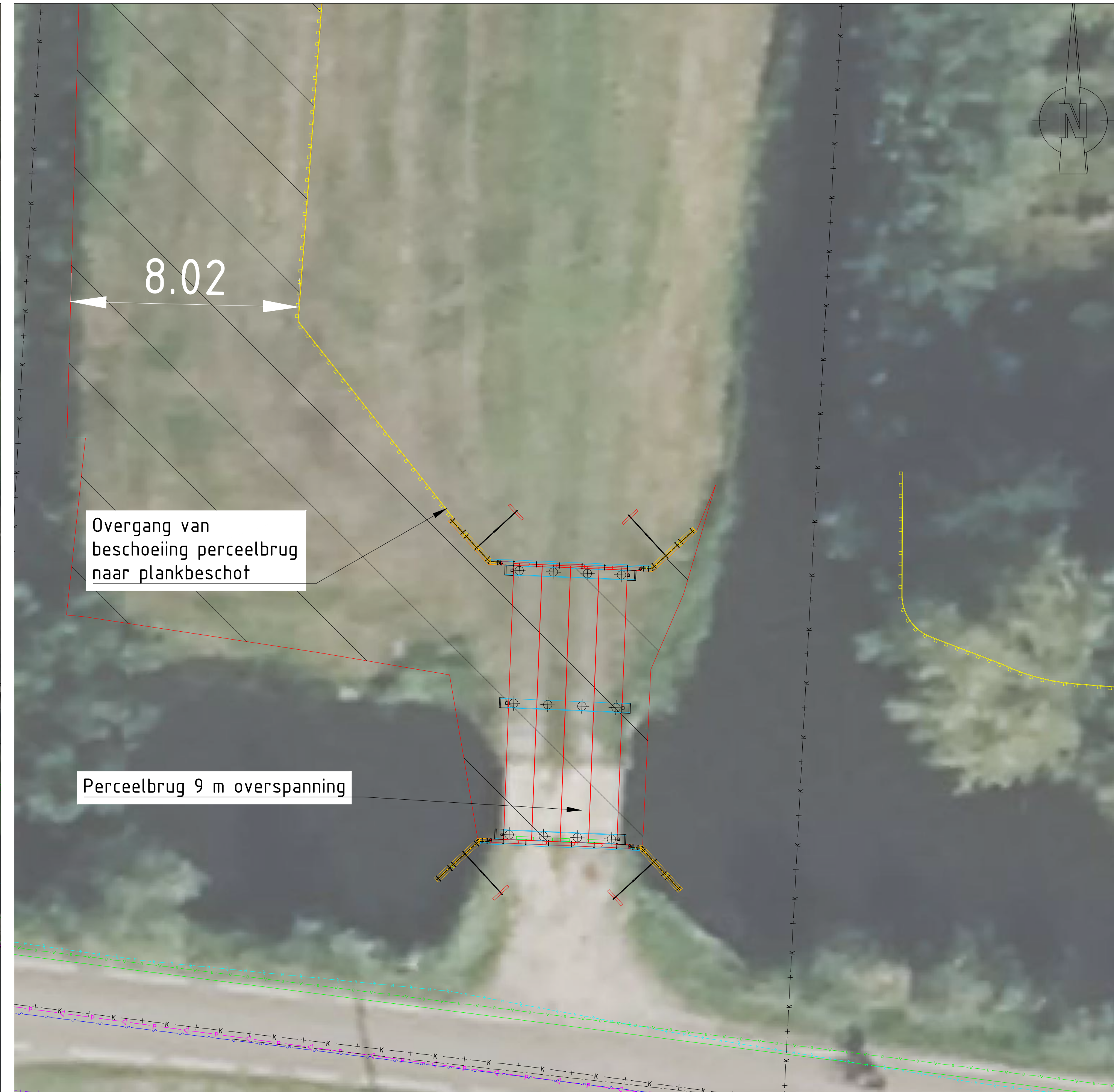
DETAIL BOVENAANZICHT SCHAAL 1 : 100
