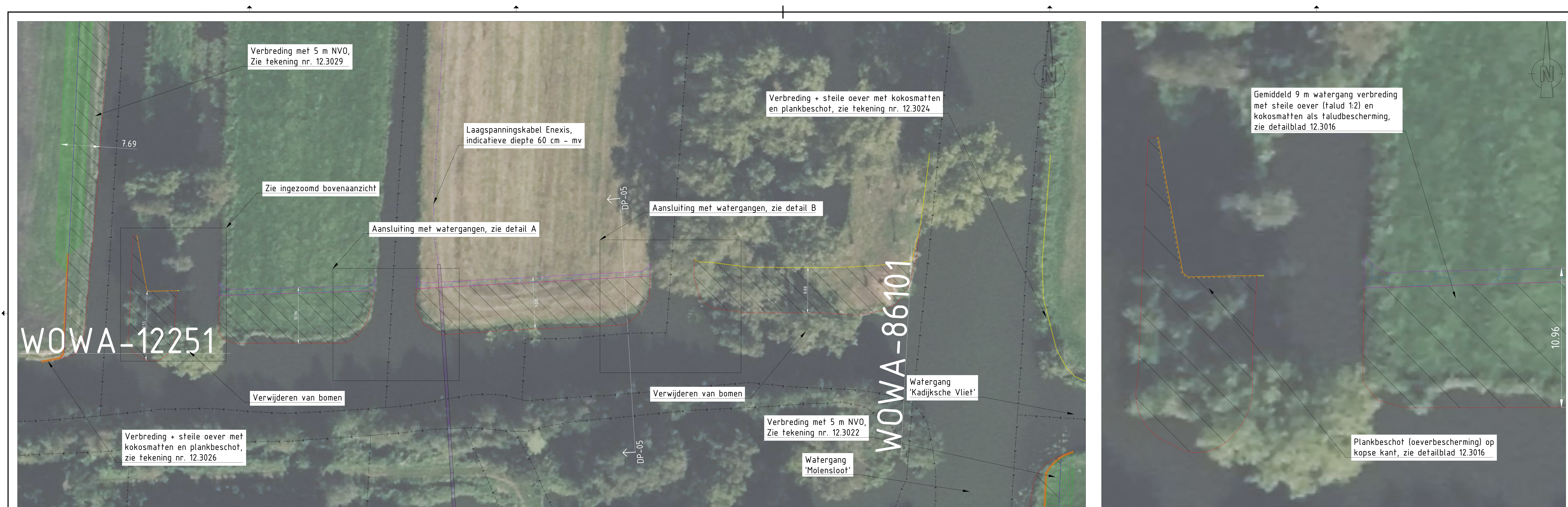
BOVENAANZICHT VAN VERBREDING MET STEILE OEVER + KOKOSMATTEN, LEGGERTRAJECT WOWA-86101 SCHAAL 1: 250
