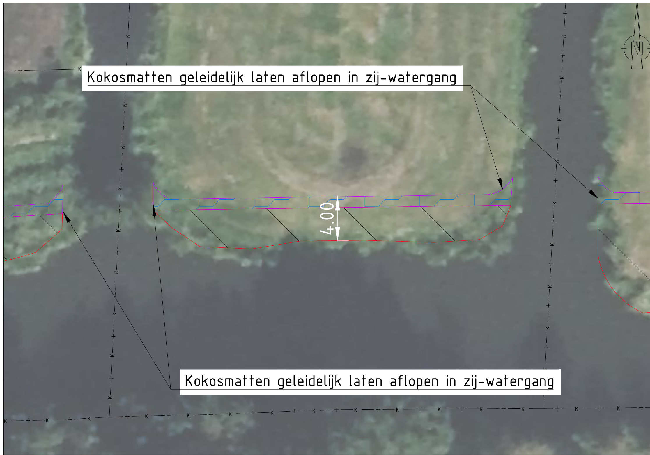
DETAIL A, LEGGERTRAJECT WOWA-86101+79159 SCHAAL 1: 200
