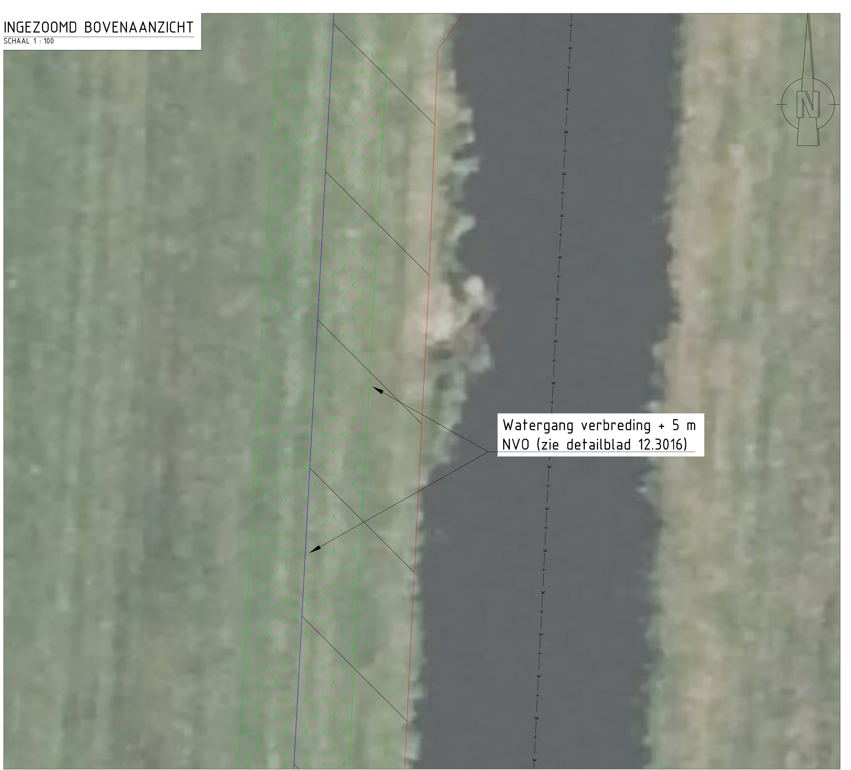
BOVENAANZICHT VAN VERBREDING MET 5 m NVO, LEGGERTRAJECT WOWA-12169 (midden vork)
