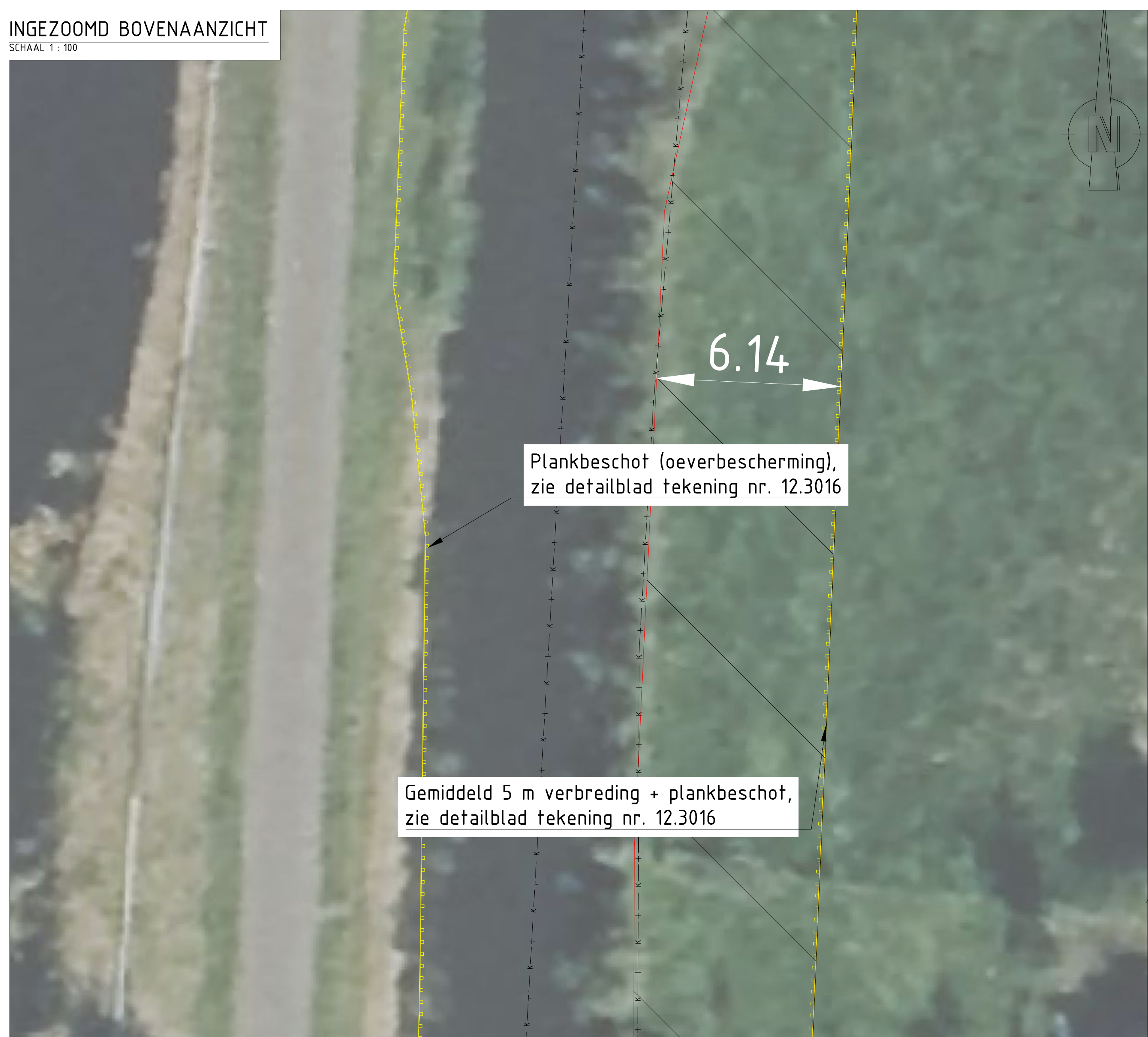
BOVENAANZICHT VAN VERBREDING MET PLANKBESCHOT, LEGGERTRAJECT WOWA-59626 (westelijke vork)
