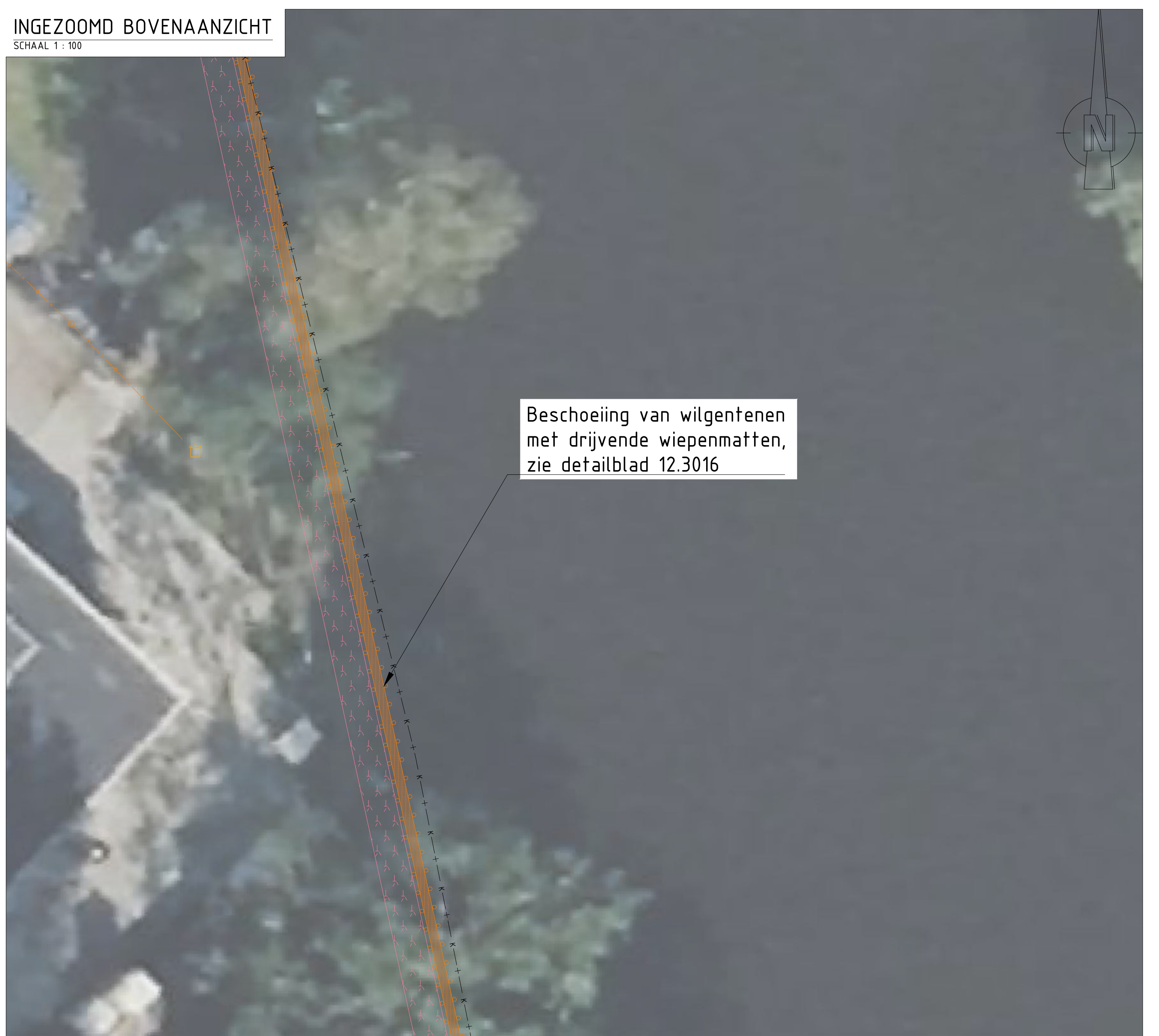
BOVENAANZICHT BESCHOEIING VAN WILGENTENEN EN WIEPENMATTEN, LEGGERTRAJECT WOWA-69263 SCHAAL 1: 500
