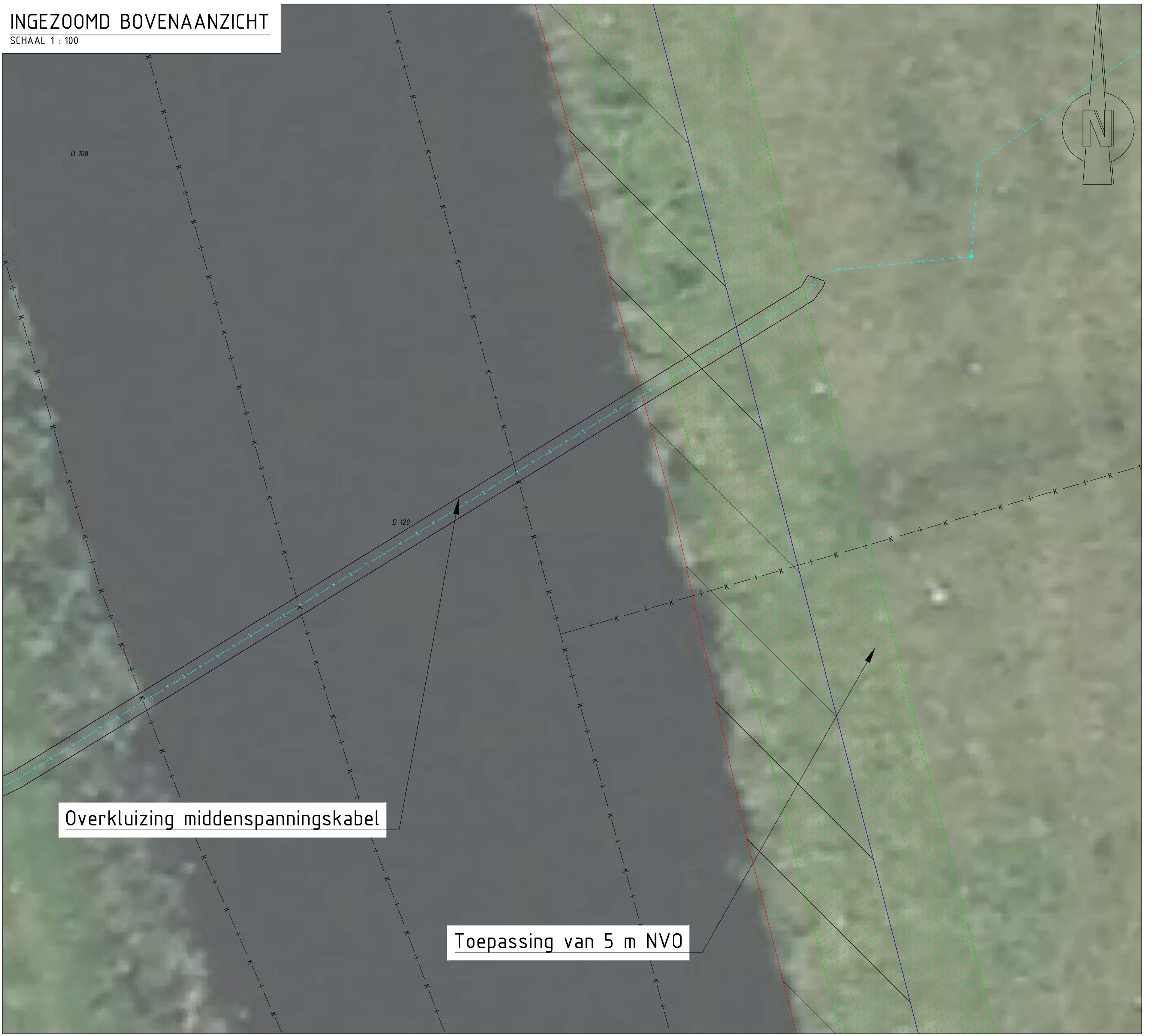
BOVENAANZICHT TOEPASSING 5 m NVO, LEGGERTRAJECT WOWA-82736 SCHAAAL 1:500
