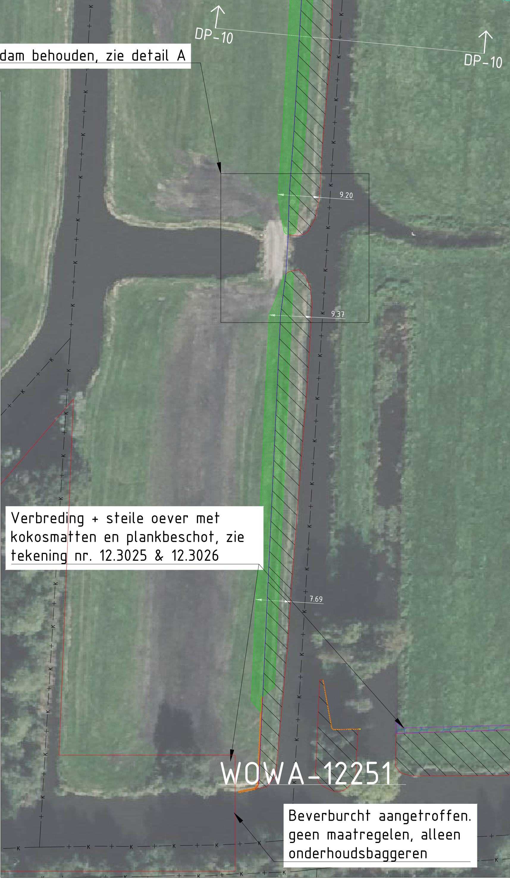
DETAIL A, LEGGERTRAJECT WOWA-12251 (midden vork) SCHAAL 1 : 200
