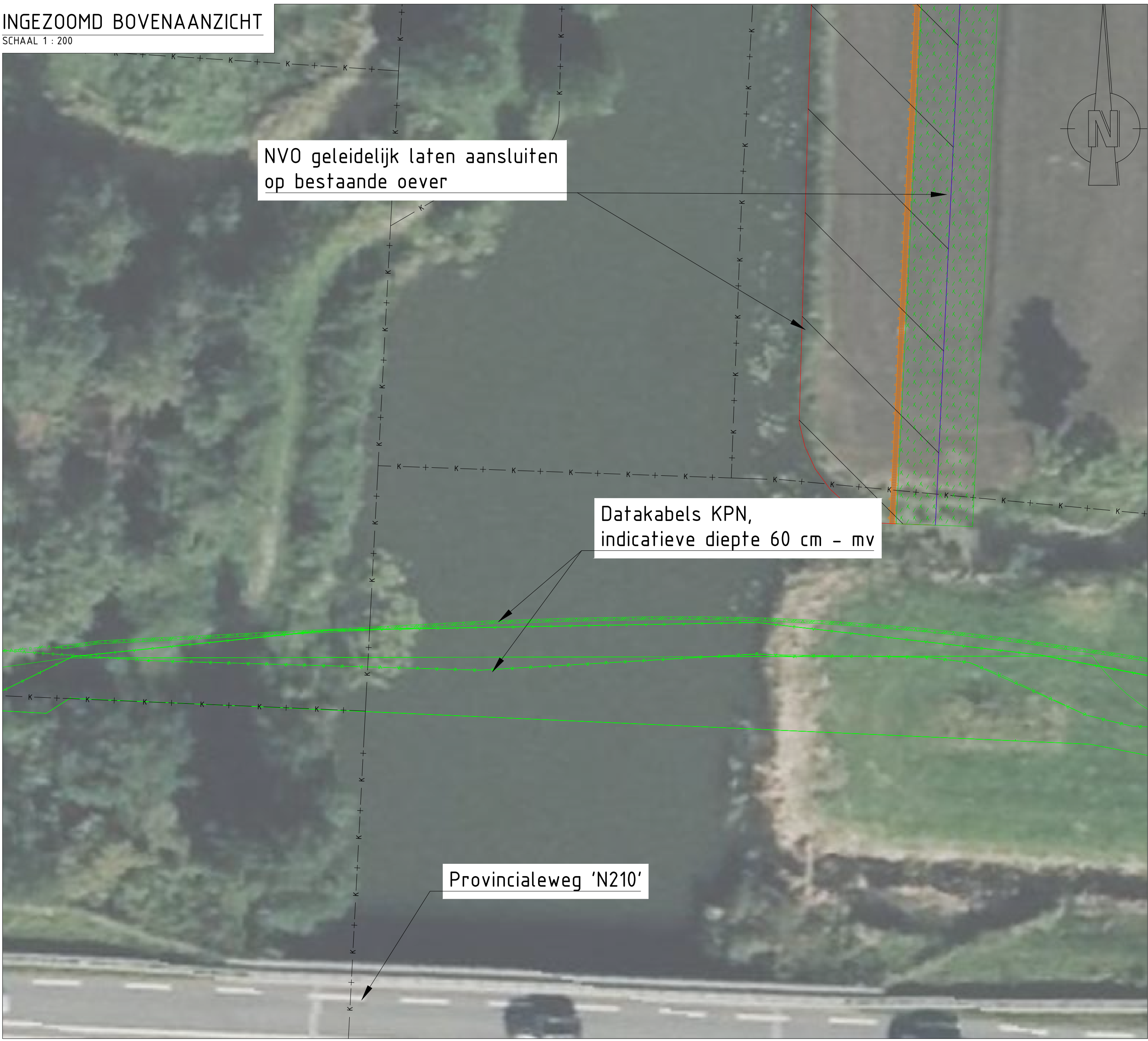
BOVENAANZICHT VAN VERBREDING MET 5 m NVO EN BESCHOEIING VAN WILGENTENEN, LEGGERTRAJECT WOWA-87154
