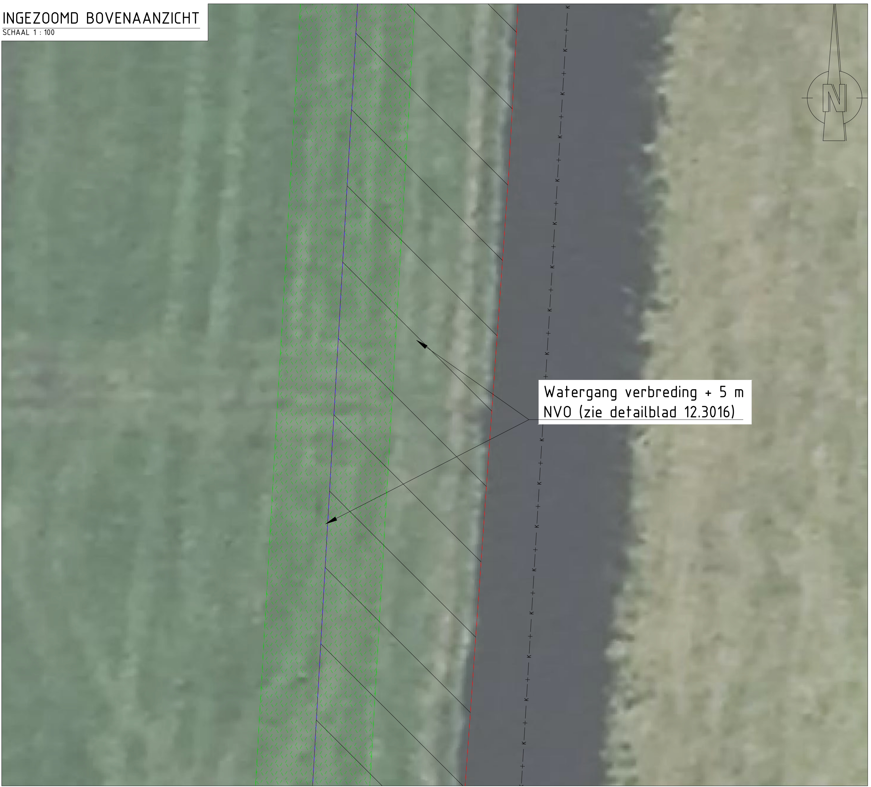
BOVENAANZICHT VAN VERBREDING MET 5 m NVO, LEGGERTRAJECT WOWA-12251 (midden vork)
