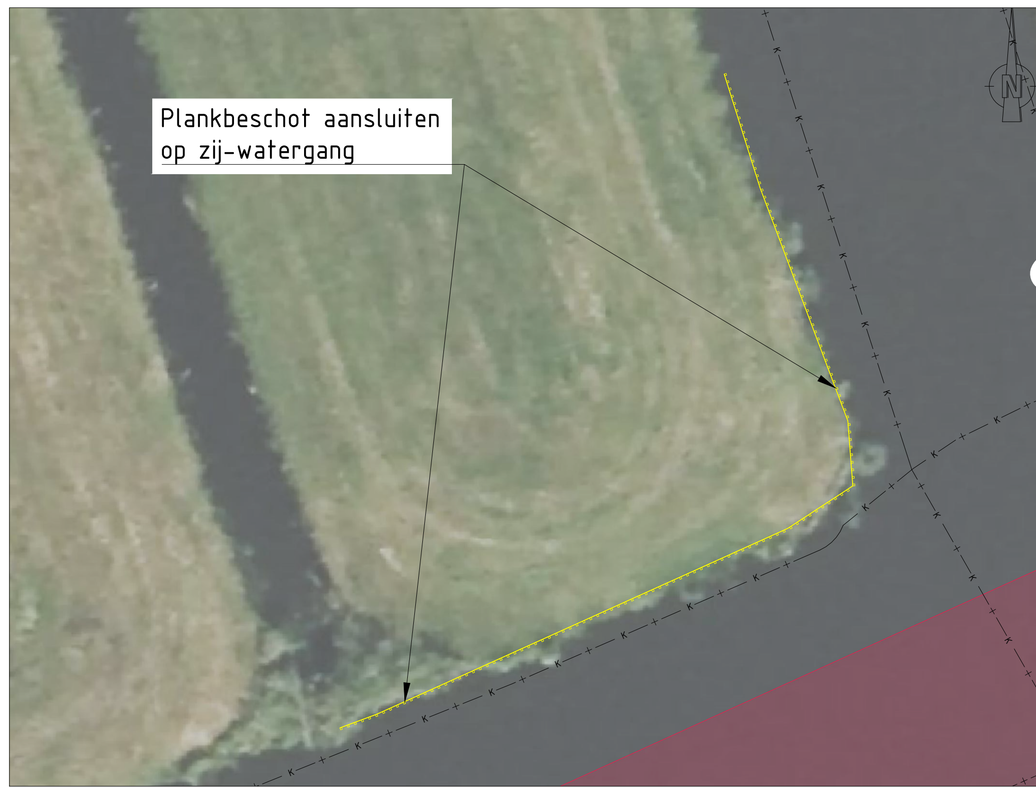
DETAIL A, LEGGERTRAJECT WOWA-74321 SCHAAL 1:200
