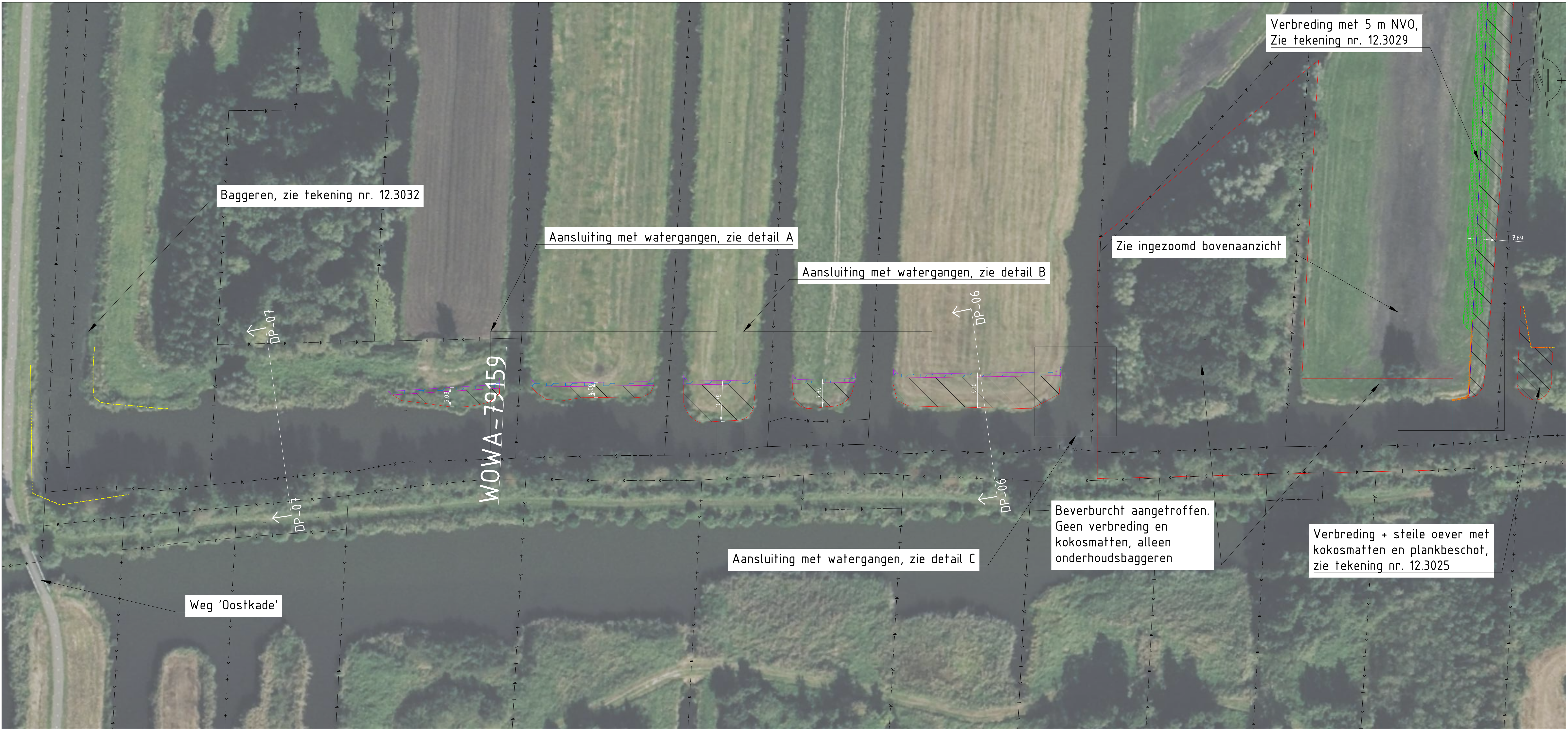
BOVENAANZICHT VAN VERBREDING MET STEILE OEVER + KOKOSMATTEN, LEGGERTRAJECT WOWA-86101+79159 SCHAAL 1: 500
