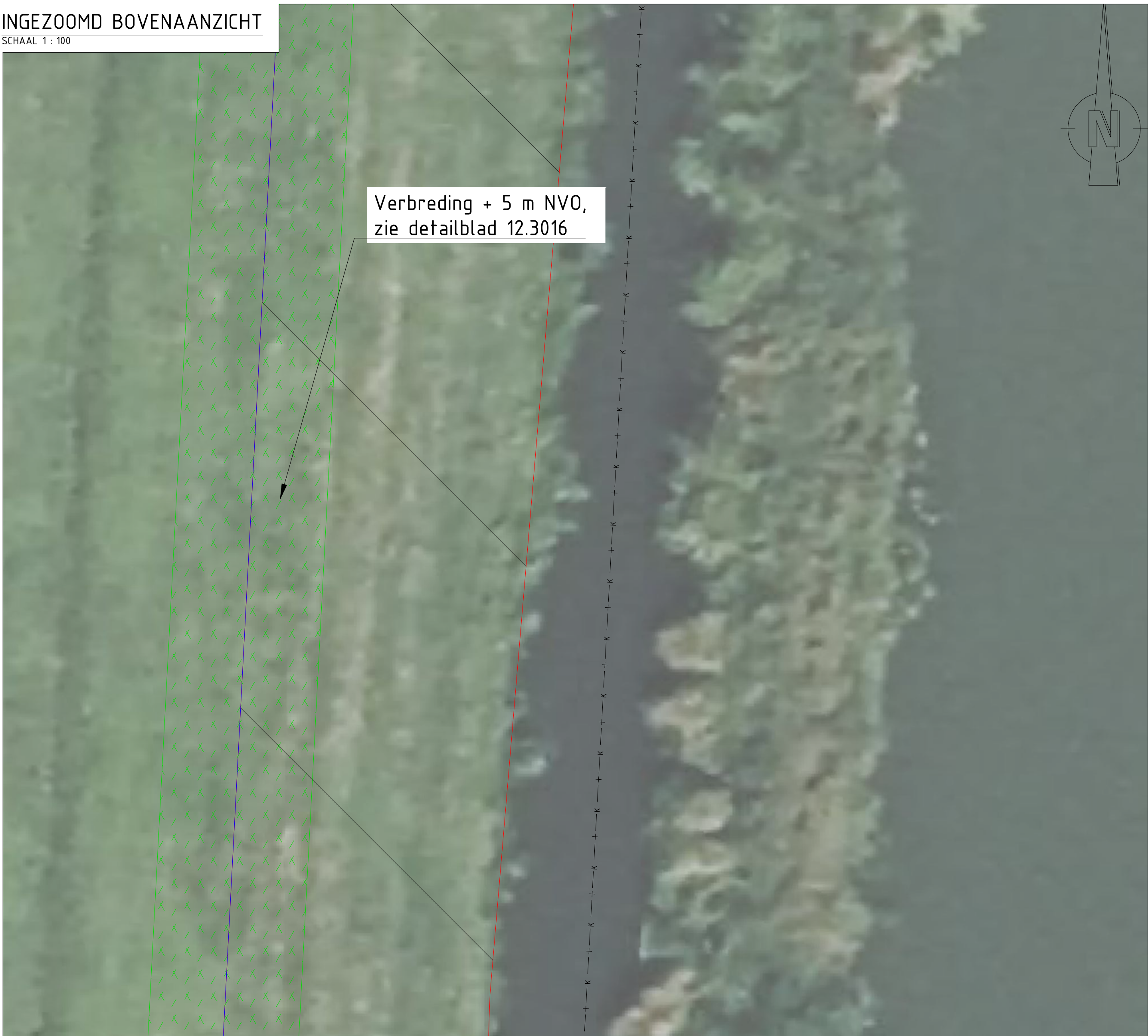
BOVENAANZICHT VAN VERBREDING MET 5 m NVO, LEGGERTRAJECT WOWA-86169
