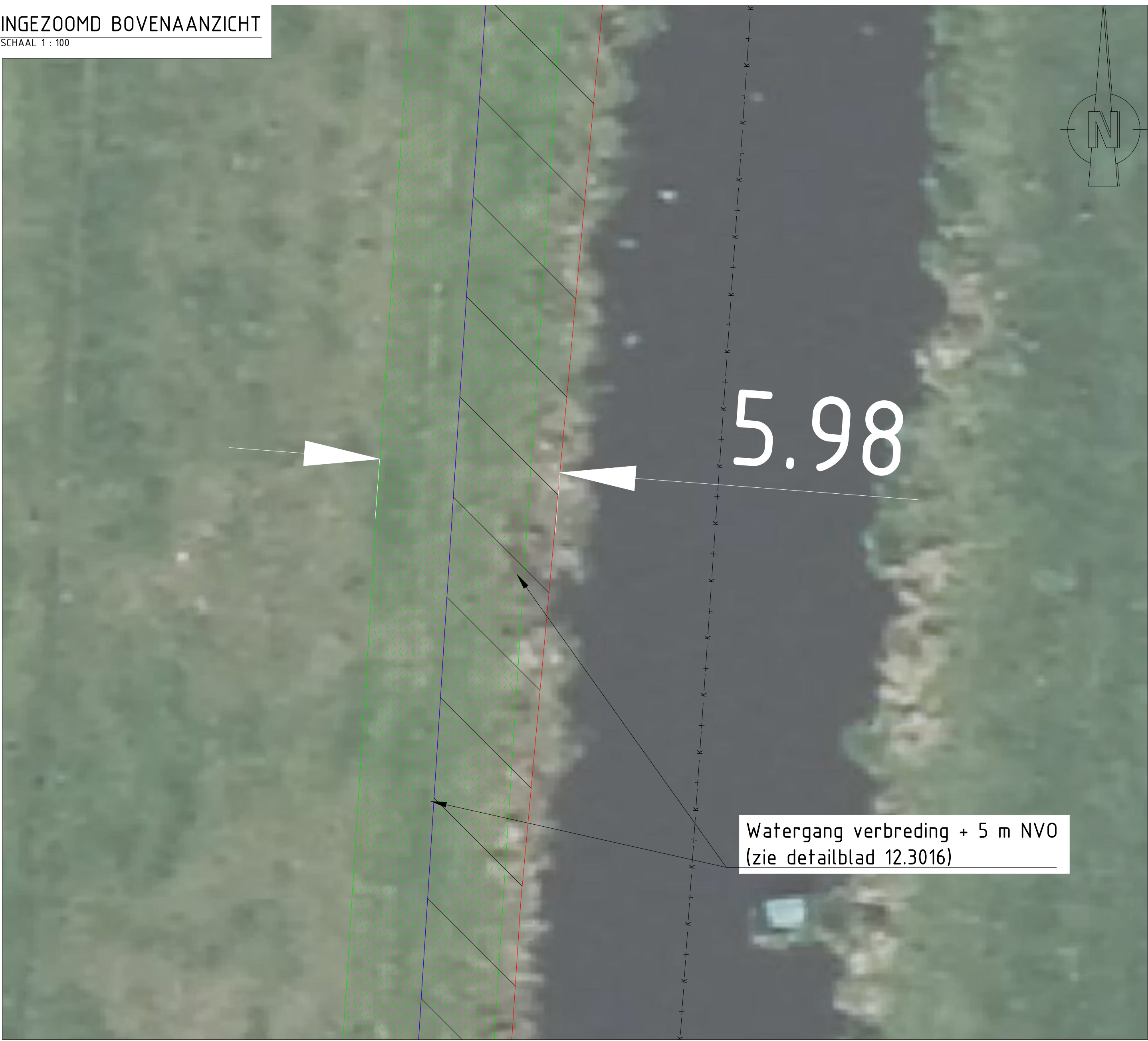
BOVENAANZICHT VAN VERBREDING MET 5 m NVO, LEGGERTRAJECT WOWA-60665 (oostelijke vork)
