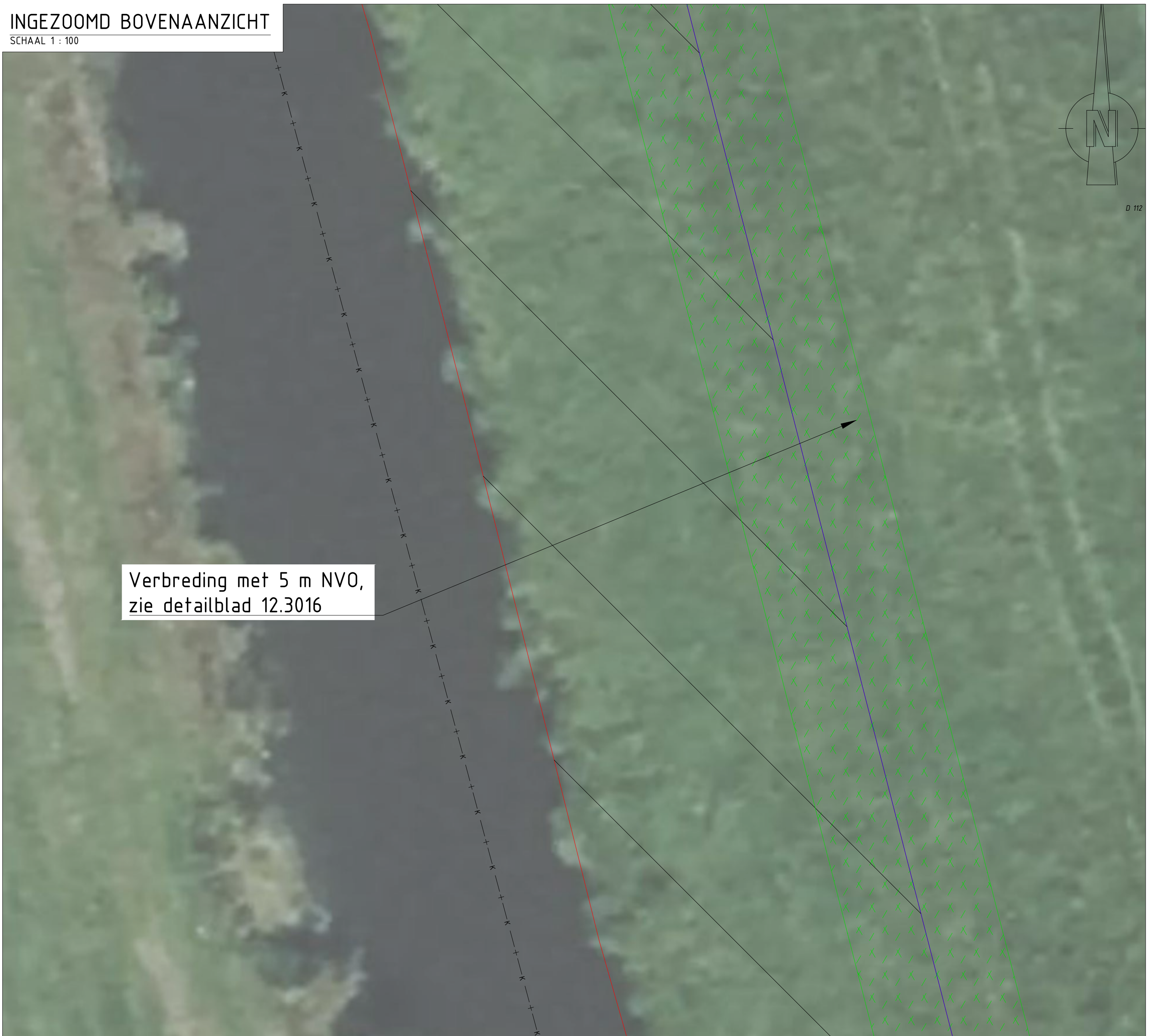
BOVENAANZICHT VERBREIDING MET NVO, LEGGERTRAJECT WOWA-54615
