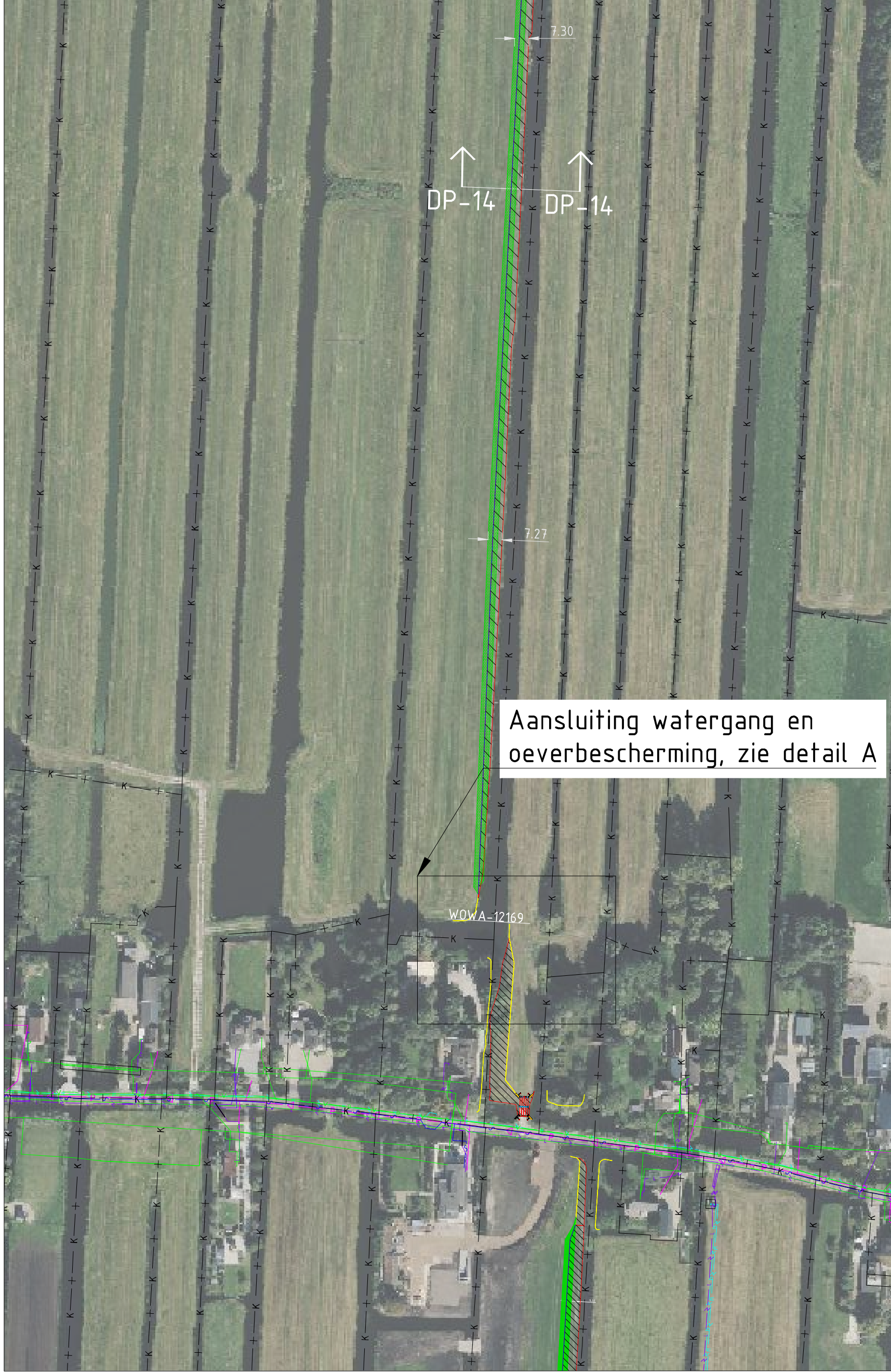
BOVENAANZICHT VAN VERBREDING MET 5 m NVO, LEGGERTRAJECT WOWA-12169 (midden vork)
