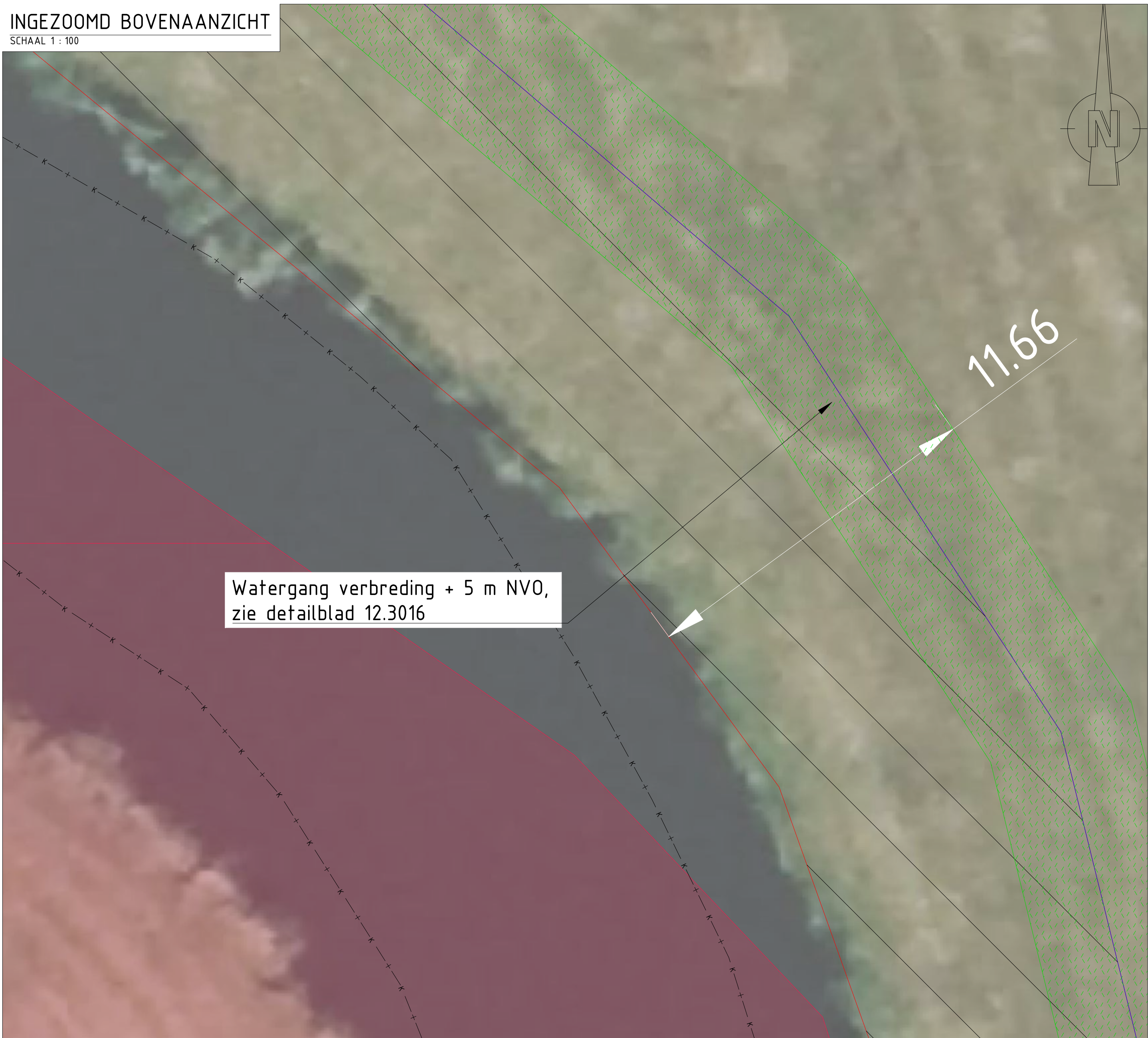
BOVENAANZICHT VERBREIDING MET NVO, LEGGERTRAJECT WOWA-79290
