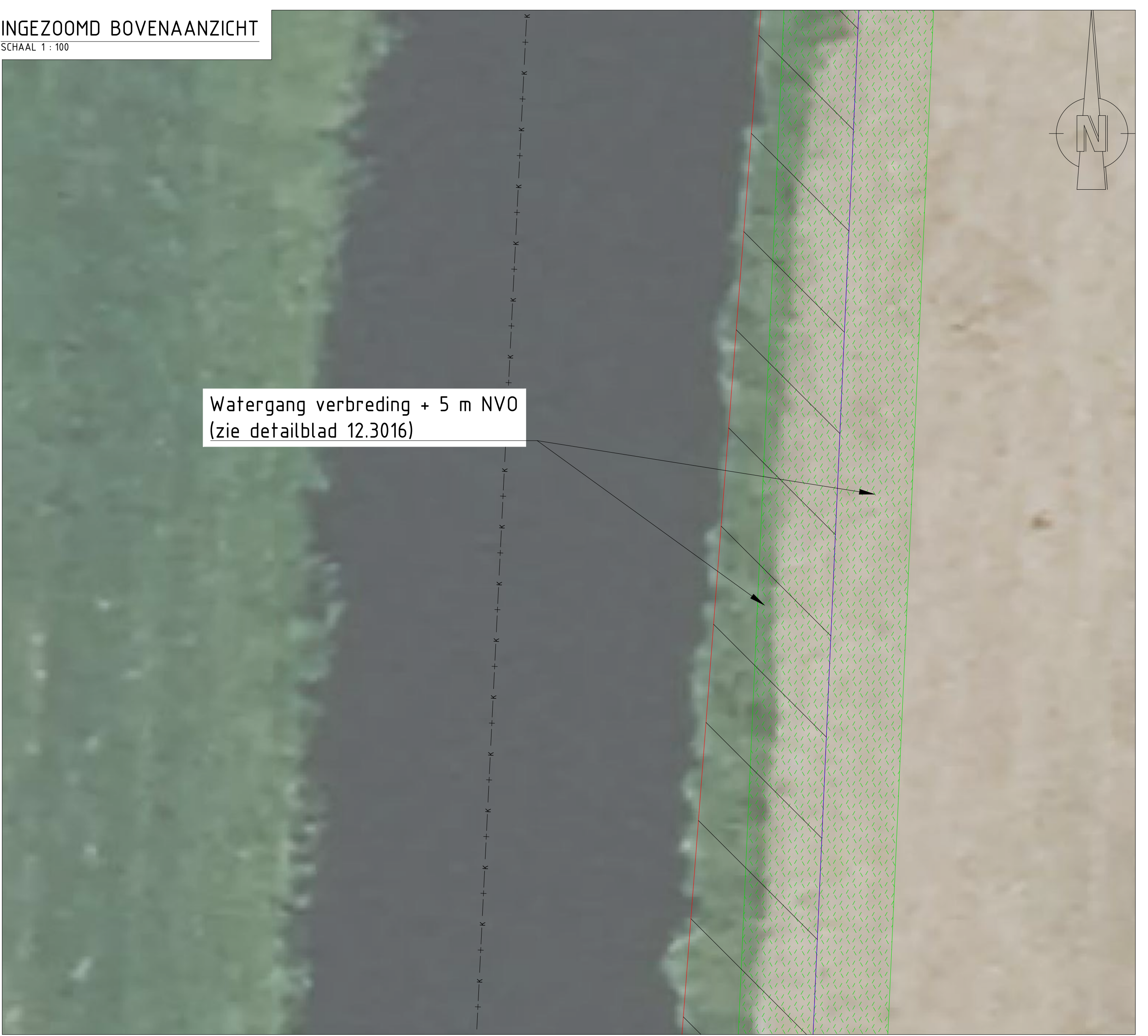
BOVENAANZICHT VAN VERBREDING MET 5 m NVO, LEGGERTRAJECT WOWA-58790 (oostelijke vork)
