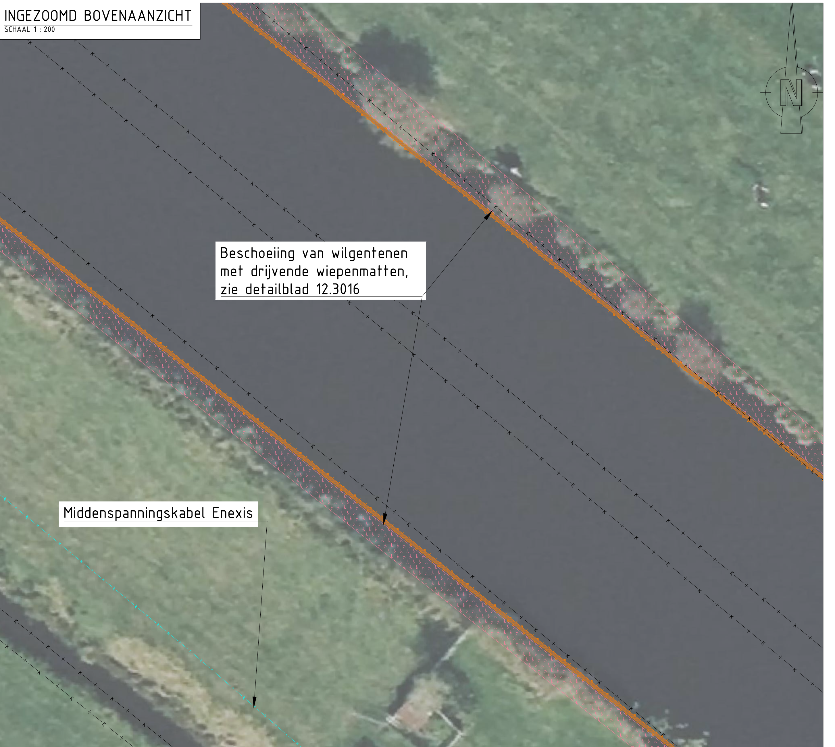
BOVENAANZICHT BESCHOEIING VAN WILGENTENEN EN WIEPENMATTEN, LEGGERTRAJECT WOWA-74146
