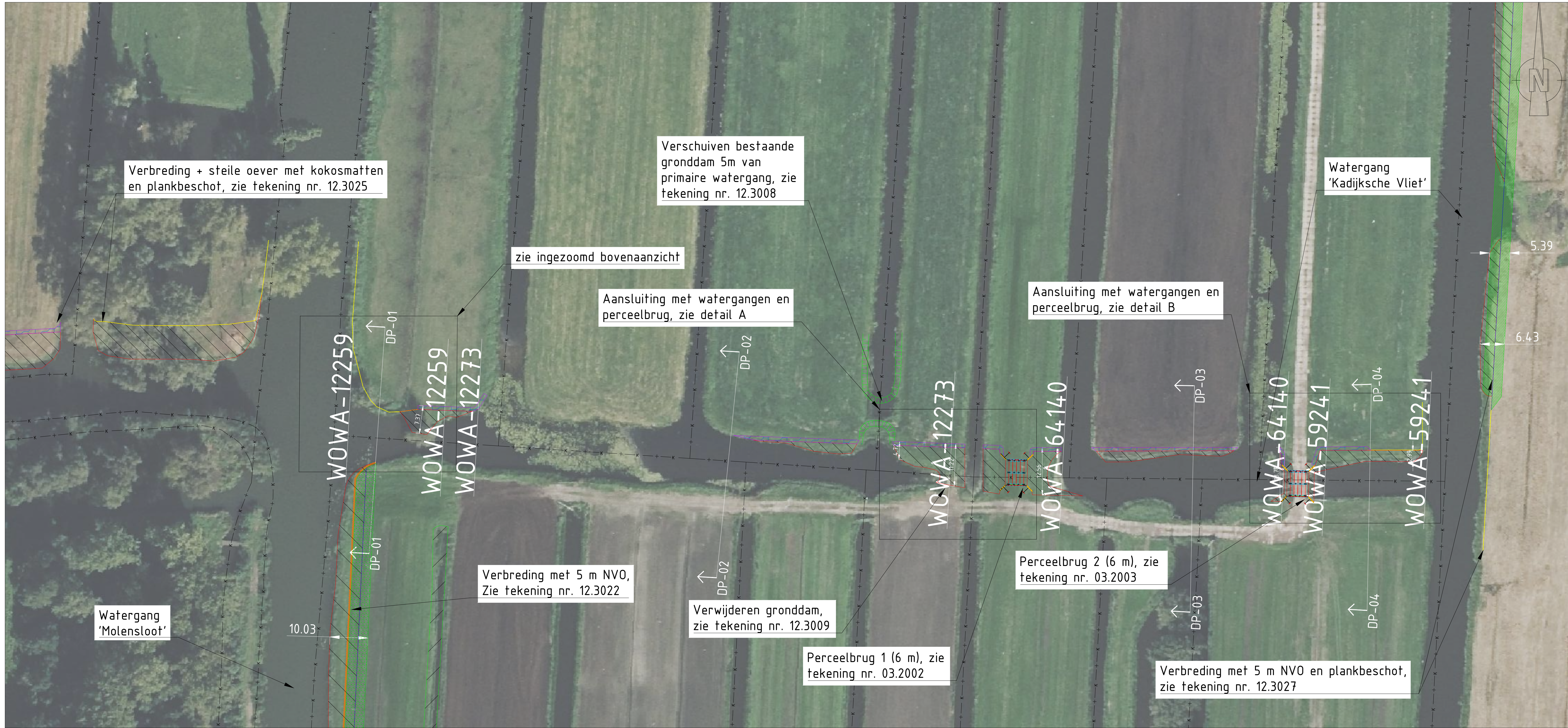
BOVENAANZICHT VAN VERBREDING MET STEILE OEVER + KOKSMATTEN, LEGGERTRAJECT WOWA-12259+12273+64140+59241 SCHAAL 1:500
