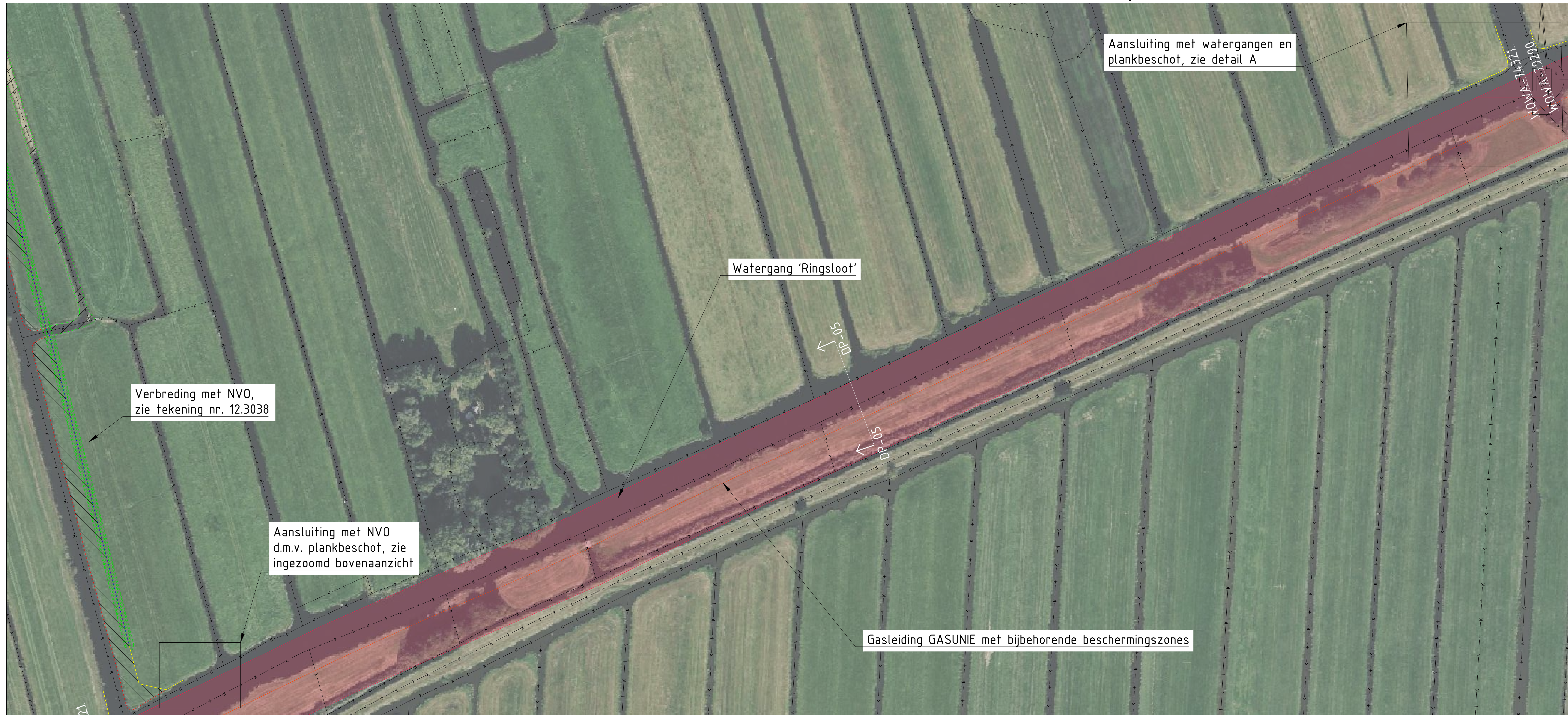
BOVENAANZICHT HERPROFILEREN, LEGGERTRAJECT WOWA-74321 SCHAAL 1:1000
