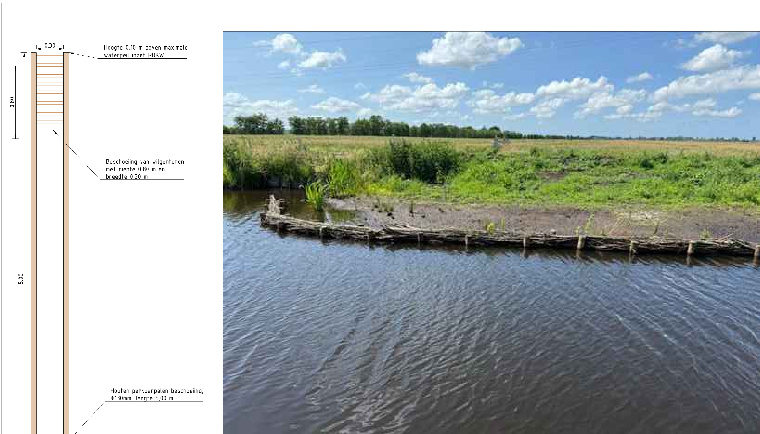
DETAILTEKENING VERBREDING MET NVO SCHAAL 1: 50
