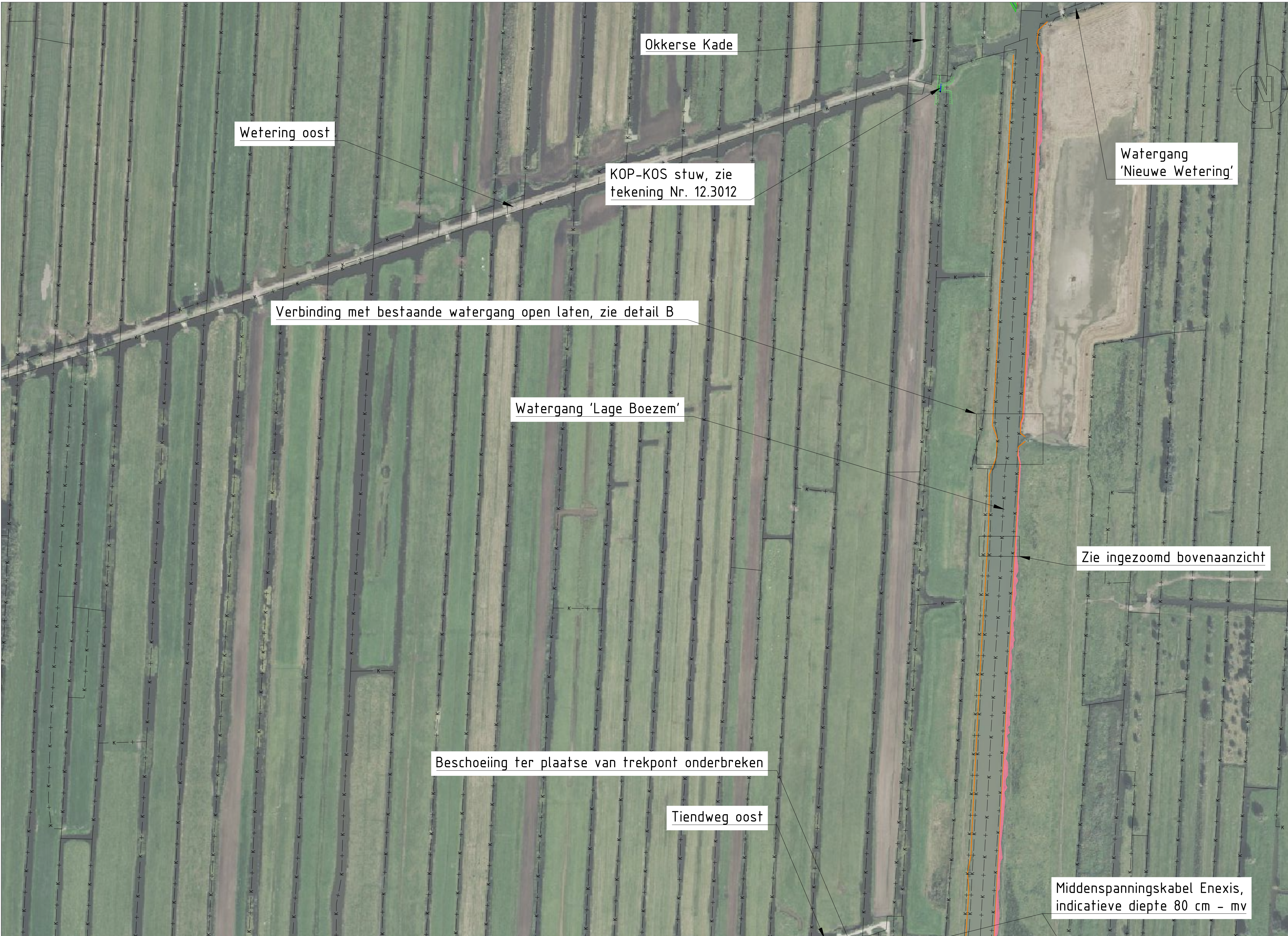
DP-02 - Aanbrengen van beschoeiing van wilgentenen en drijvende wiepenmatten en pantanetgaas, leggertraject WOWA-60832
