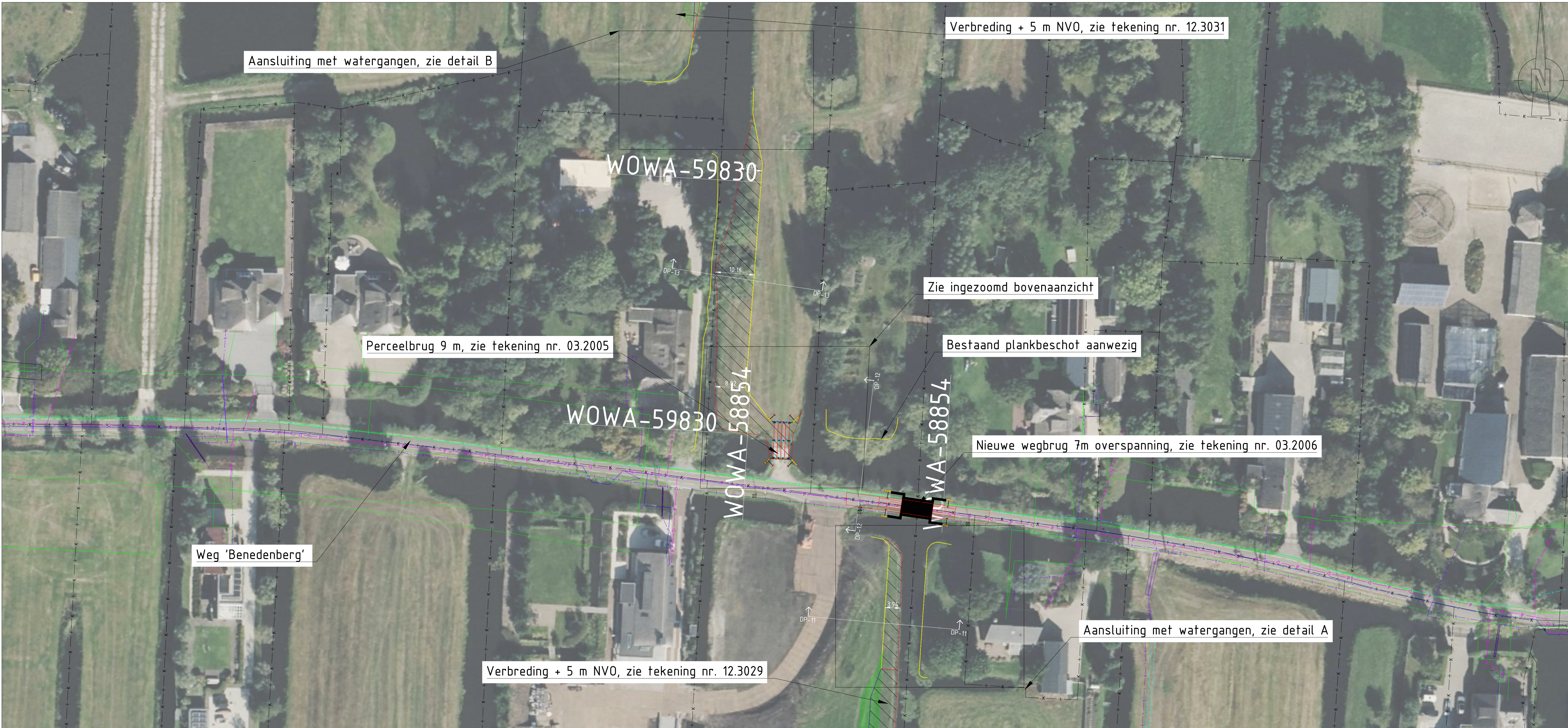
BOVENAANZICHT VAN VERBREDING MET PLANKBESCHOT, LEGGERTRAJECT WOWA-58854+59830 SCHAAL 1 : 500
