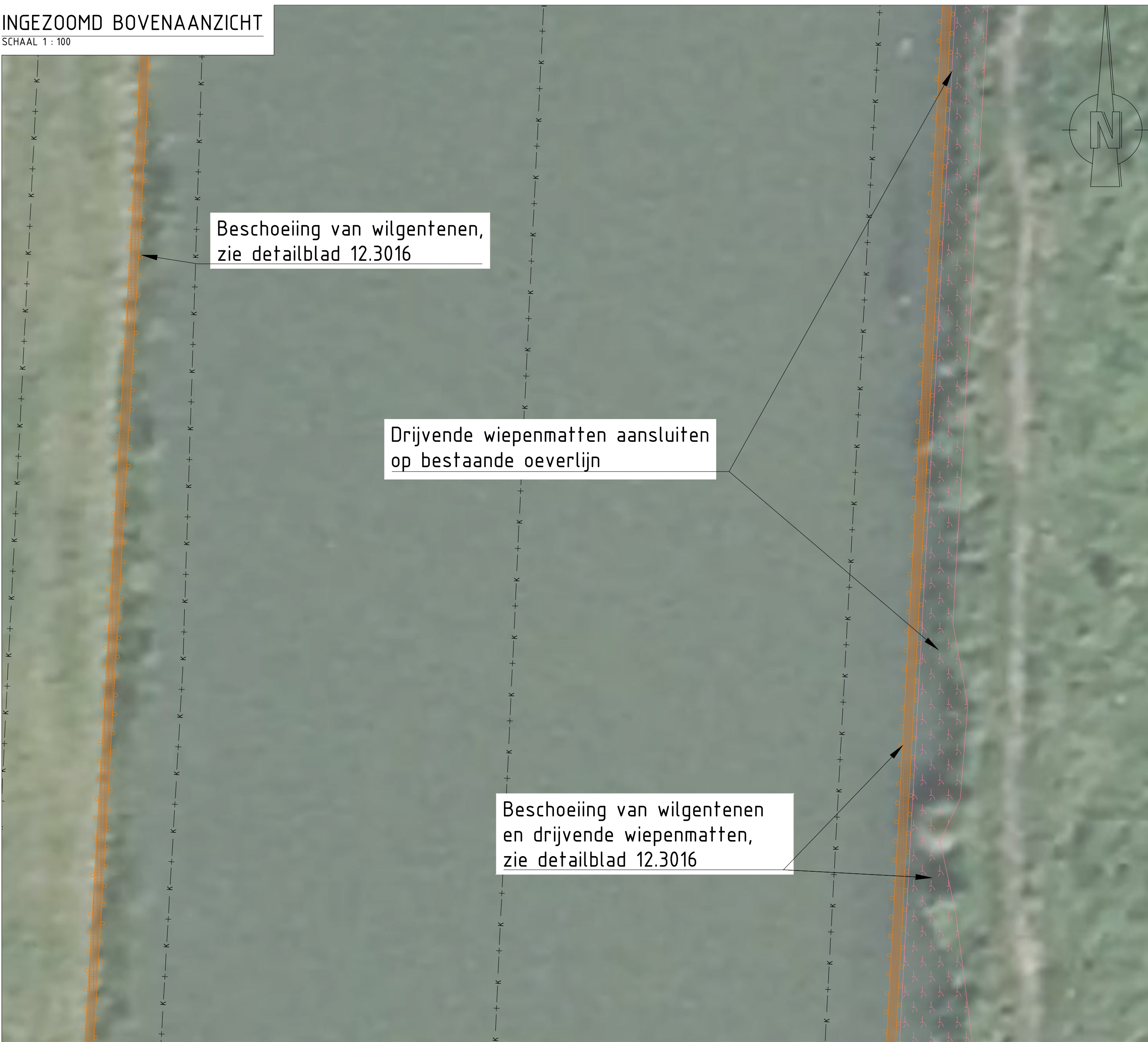
BOVENAANZICHT VAN BESCHOEIING VAN WILGENTENEN MET DRIJVENDE WIEPENMATTEN EN PANTANETGAAS, LEGGERTRAJECT WOWA-60832+86735 SCHAAL 1:2000
