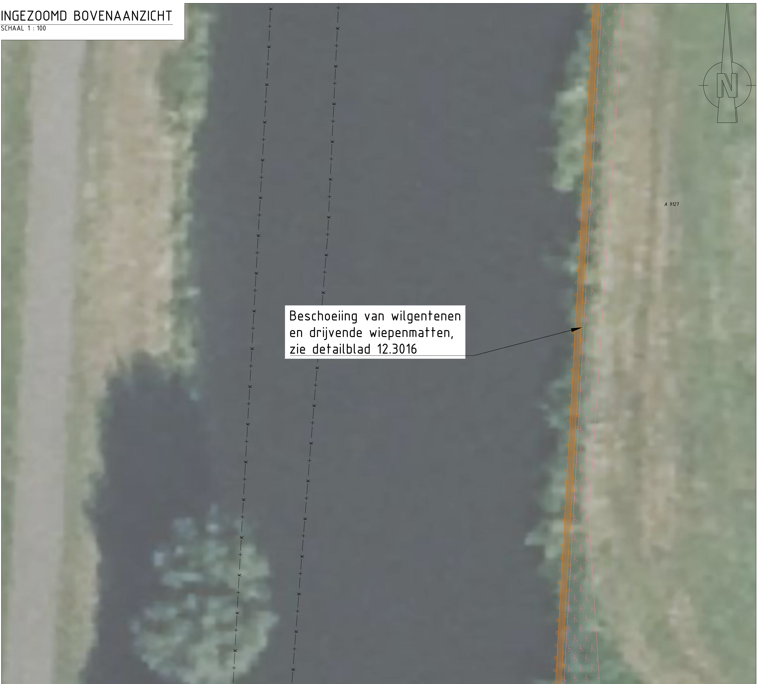
BOVENAANZICHT BESCHOEIING VAN WILGENTENEN + WIEPEN,MAT LEGGERTRAJECT WOWA-29034 (westelijke vork)
