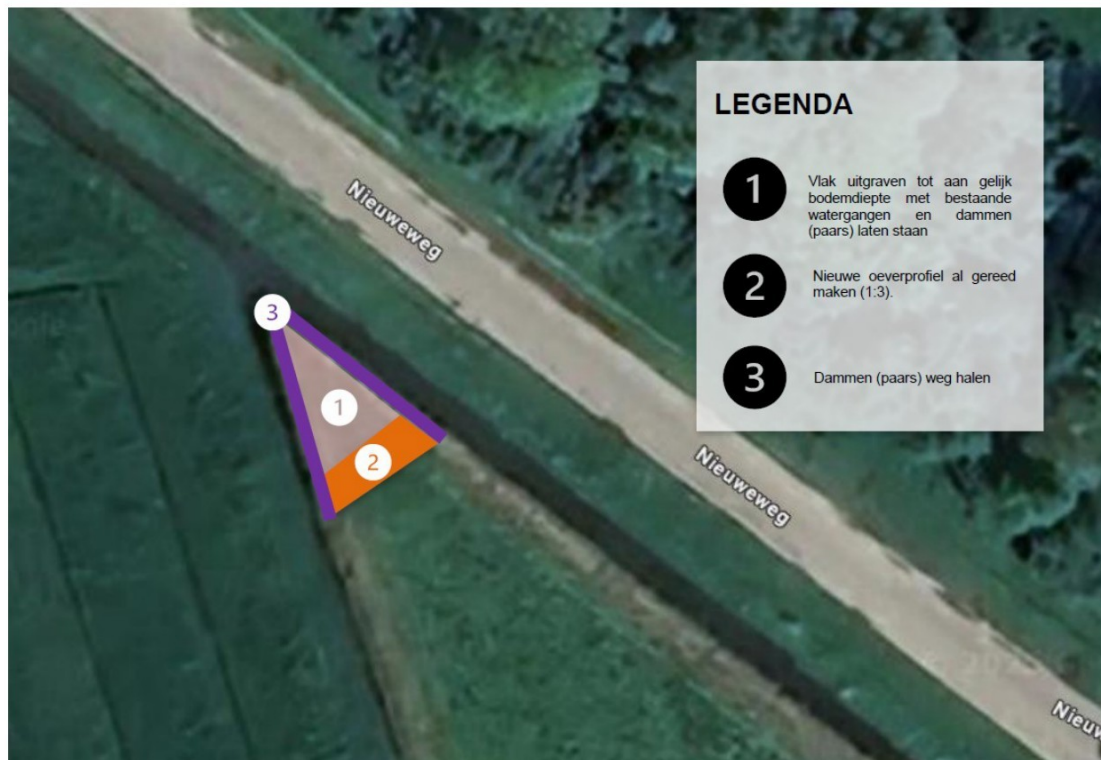
Figuur 5. Luchtfoto van de noordelijke punt van perceel 1615, waarop de werkvolgorde voor het realiseren van een waterberging en een natuurvriendelijke oever inzichtelijk is gemaakt. De technische details zoals afmetingen zijn weergegeven in figuur 3 van bijlage 3 bij dit besluit.
