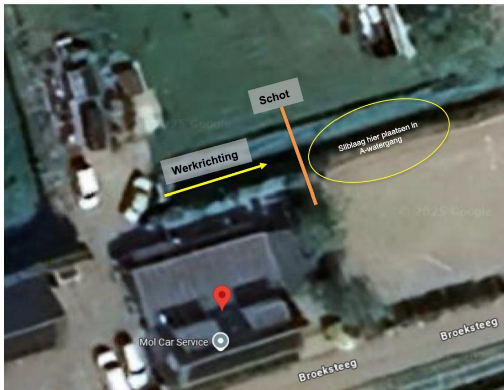
Figuur 6. Luchtfoto van de te dempen A-watergang tussen percelen 893 en 1615, waarop de werkriching, de situering van het schot en de locatie van de overgezette sliblaag inzichtelijk is gemaakt.
