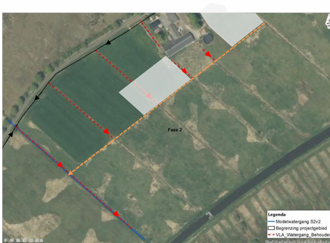
Figuur 7: Ligging watergangen bij perceel VDR00-G-817. Oranje watergang is nieuw te graven en verbindt de bestaande greppels met de nabijgelegen A-watergang. Als koppelkans wordt voorgesteld om in de zwarte bermsloot ter hoogte van de woning de duikers te vervangen zodat afwatering op de A-watergang van het waterschap (rood-blauw gestippeld) weer mogelijk wordt.
