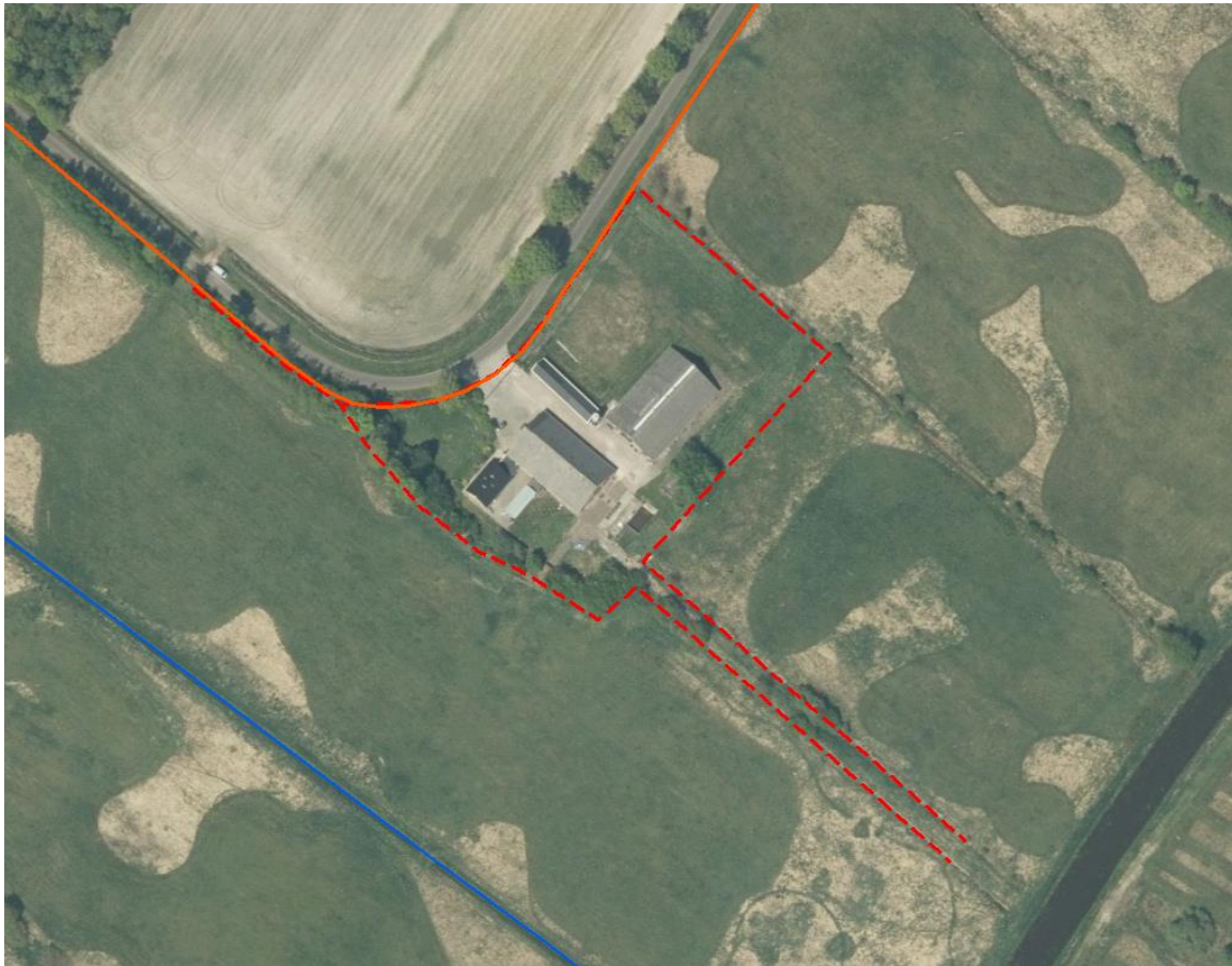
Afbeelding 6.13 Te behouden watergangen en aan te leggen watergangen rondom Madeweg 7
