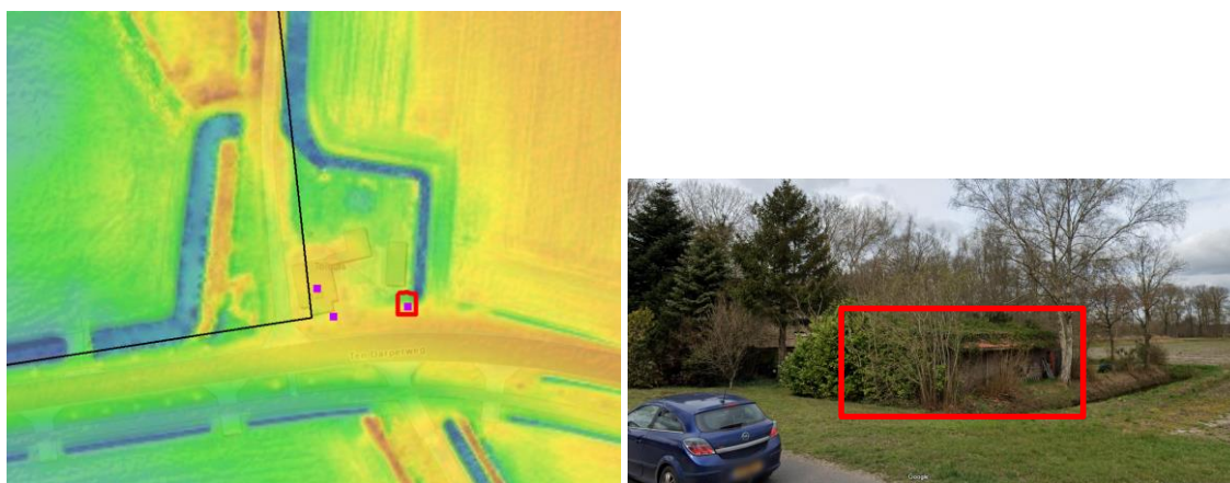
Afbeelding 8.7 Situatie panden bij het Tolhuis, aan de Ten Darperweg. Rood aangegeven meetpunt is waar het ontwateringscriterium wordt overschreden. Het gaat hier waarschijnlijk om een schuur/bijgebouw
