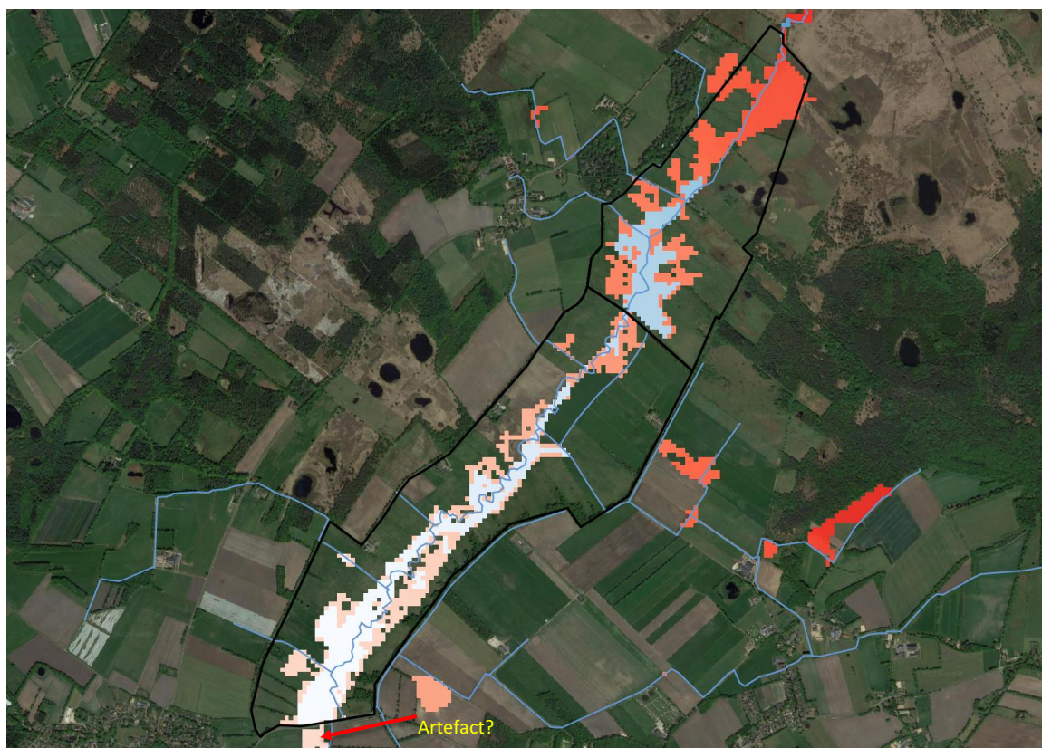
Afbeelding 6.5 Inundatiebeeld T1 (blauwe cellen) en T10 (rode cellen), variant herstel oude meander. De blauwe lijnen stellen de 1D-modelwatergangen voor van het ontwerp
