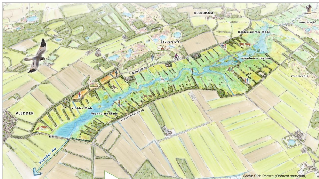
Figuur 2. Winter-impressie. In de winter of het voorjaar kan het echter voorkomen dat de Vledder Aa juist een zeer grote afvoer heeft. De slenk zal dan niet toereikend zijn en delen van het beekdal zullen onder lopen. Het is feitelijk eenzelfde situatie als we bij de grote rivieren zien, waar de uiterwaarden onderlopen. Het beeld van een mogelijke wintersituatie is hieronder weergegeven.
