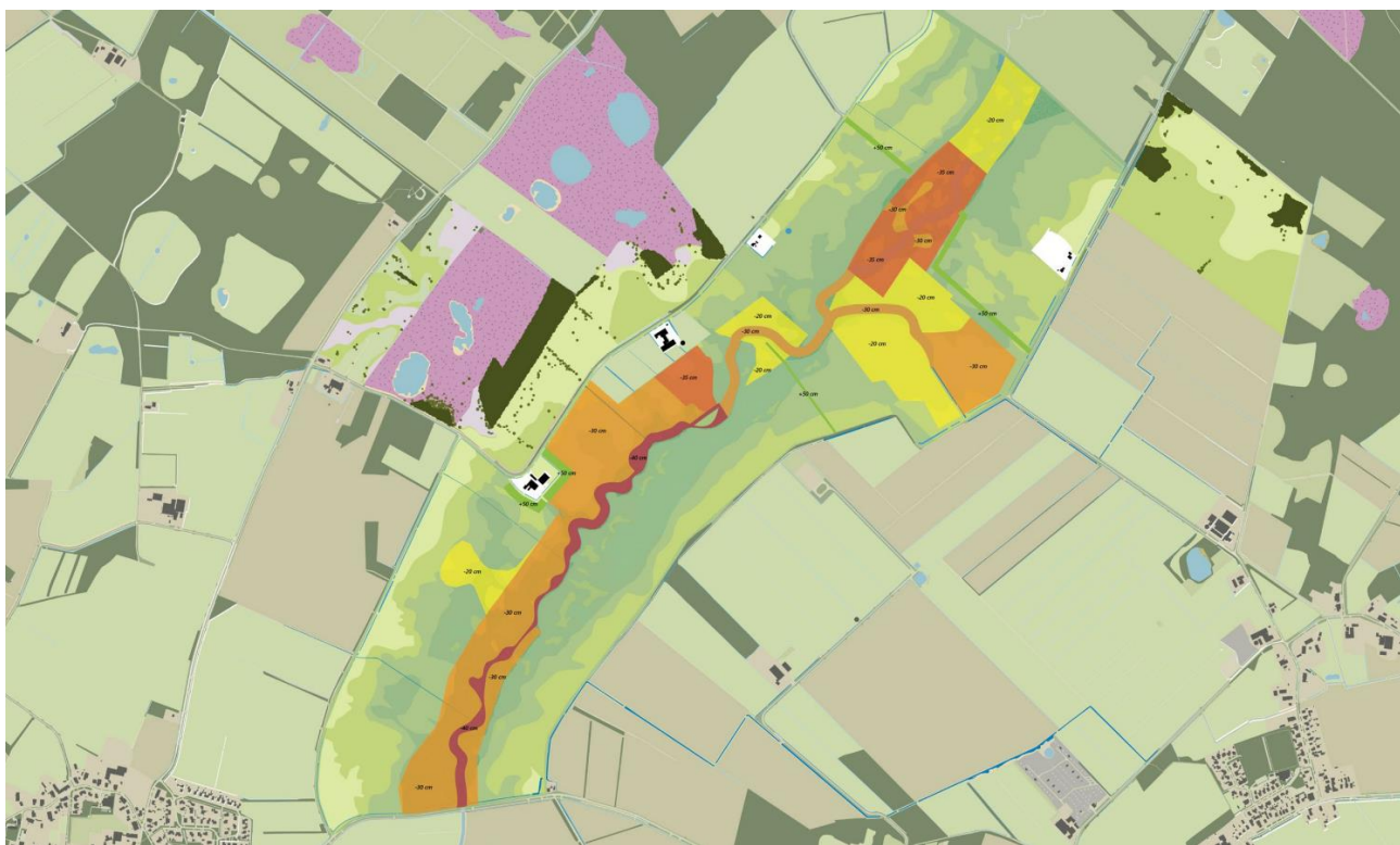
Figuur 4. Ontgravingenkaart met dieptes t.o.v. maaiveld. De slenk in het zuiden van het plangebied is in rood weergegeven (40-60 cm -Mv.). De zonering voor het plaggen is onderverdeeld in donkeroranje (35 cm -Mv.), oranje (30 cm -Mv.) en geel (20 cm -Mv.). Ook zijn er een aantal aan te leggen kades weergegeven in groen (50 cm +Mv.). Zie ook Figuur 10.
