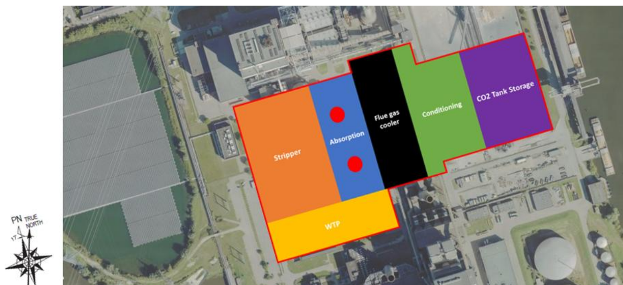
Figuur 3 Overzicht locatie LSCCP en relevante emissiebronnen zijn in het rood aangegeven (bron RHDHV-rapport)
