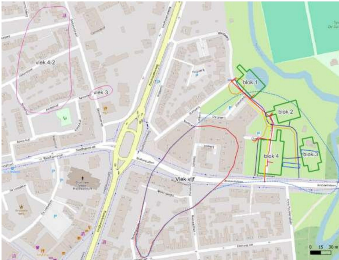
Figuur 7-7 Verontreinigingscontour nabije verontreinigingen. De meet nabije VOCL verontreiniging (vlek vijf) is weergegeven zoals ingetekend door Sweco op vlaggenkaarten uitgegeven op 20 april 2023 (rood omljnd) en 20 april 2024 (blauw gestippeld omljnd); in het oranje is de nikkel verontreiniging weergegeven
