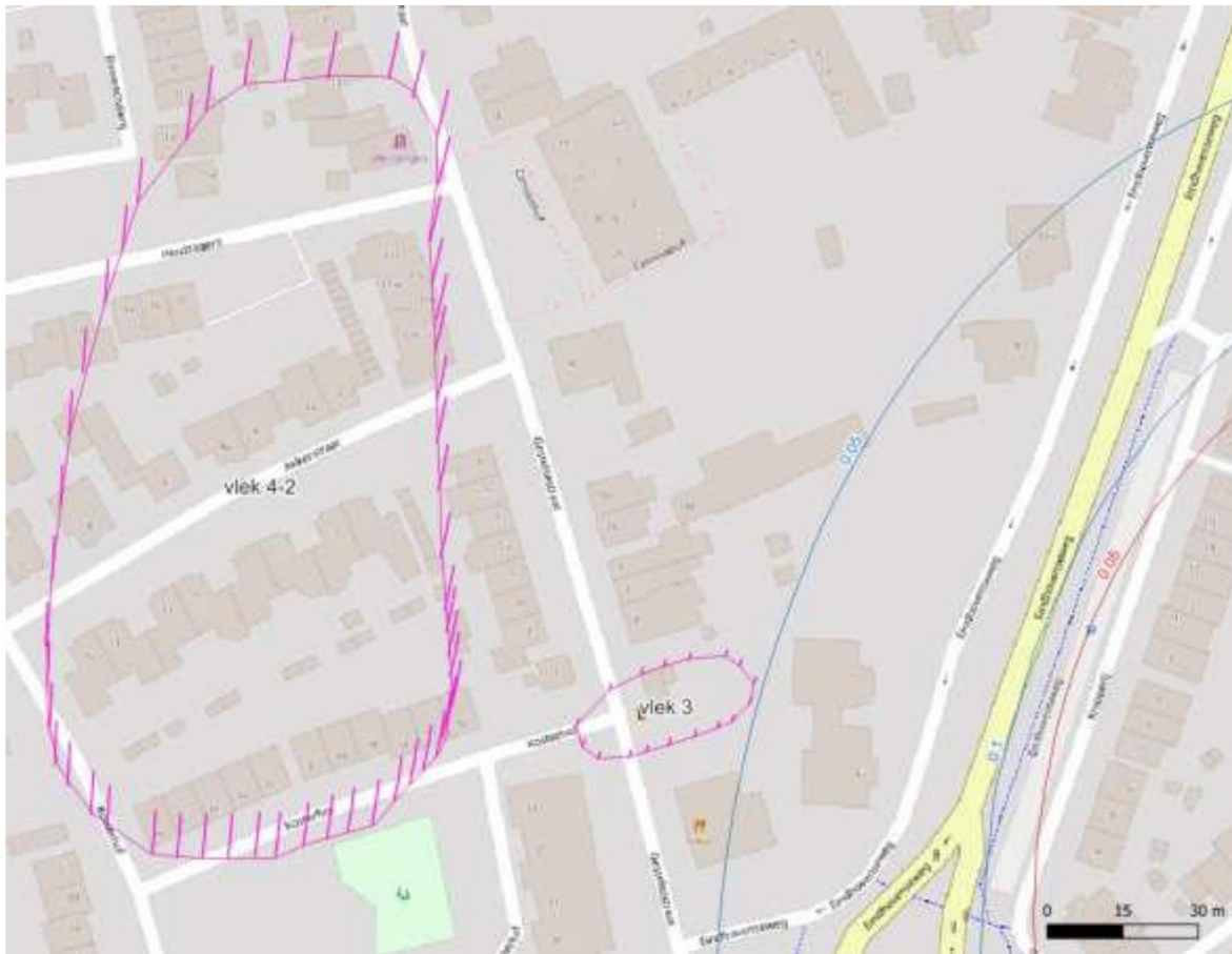
Figuur 7-11 Overzichtstekening met links 'vlek 4-2' en rechts 'vlek 3' (zie eventueel figuur 7-7 voor een overzichtstekening) en in het violet de stromingsweg van het grondwater (berekend voor een aantal punten op de verontreinigingscontour) vanaf de start van de bemaling; met in het blauw de samengestelde verlagingen voor week 29 (zie ook figuur 7-1)
