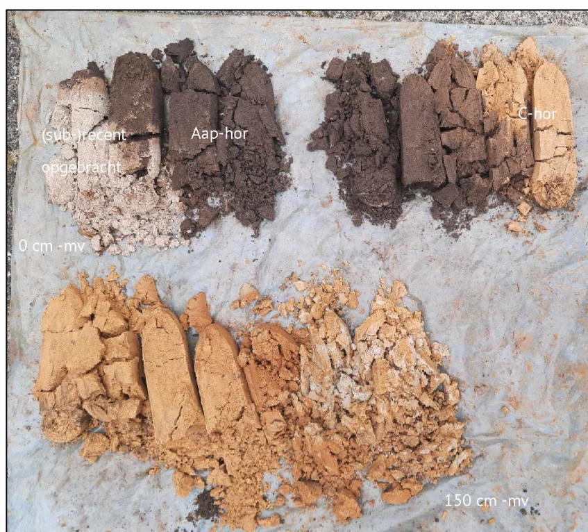
Figuur 7. Foto van boring 3. De leesrichting is van linksboven naar rechtsonder (0 – 150 centimeter) (Foto: 14 oktober 2024).
