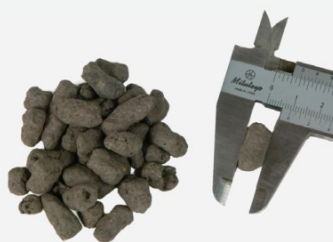
Pellet lengte 7 – 12 mm
