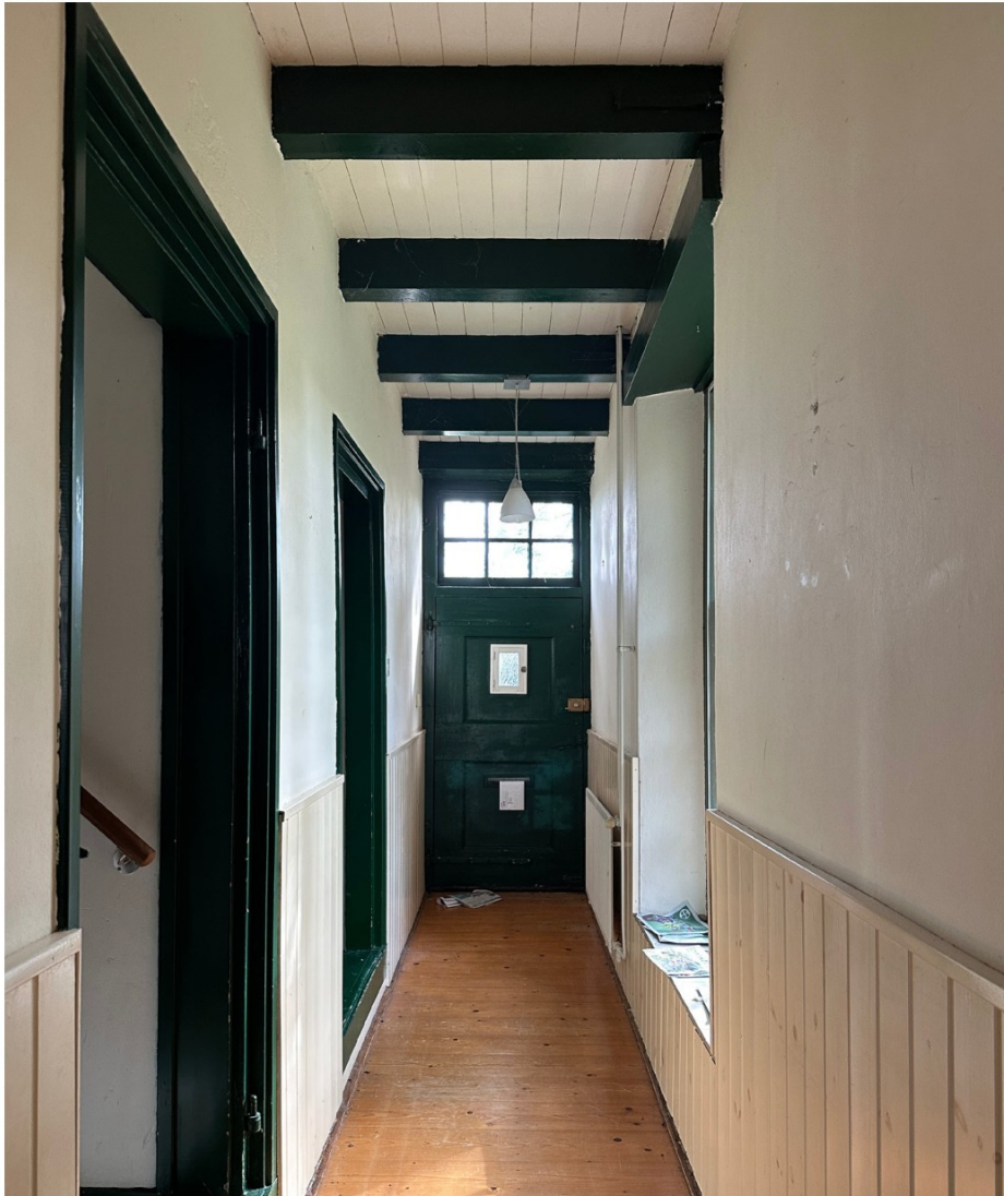
Afbeelding 88. Ruimte 0.01, gang en toegang van de woning. Deze gang was in de oorspronkelijke plannen langer maar werd ingekort om ruimte 0.05 groter te maken.
