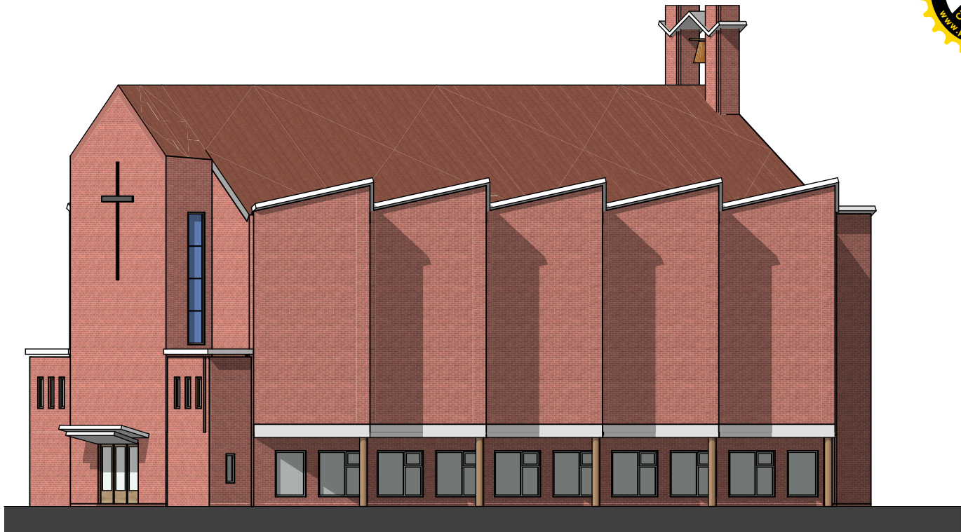
Straatgevel parallel zaagtand (metselwerk)
