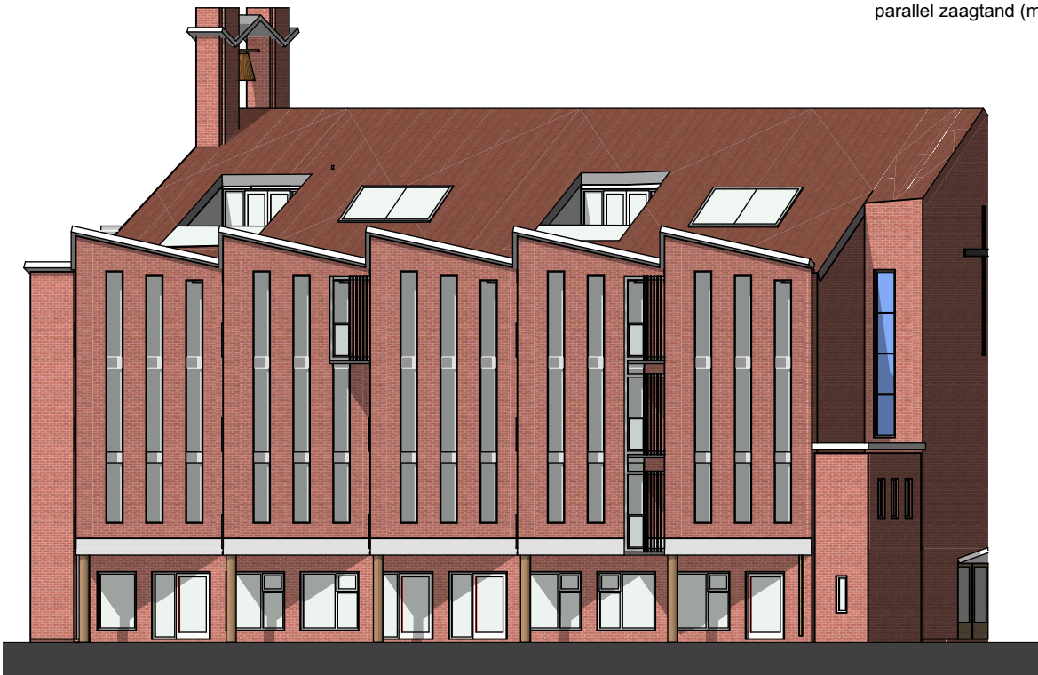
Singelgevel parallel zaagtand (metselwerk)
