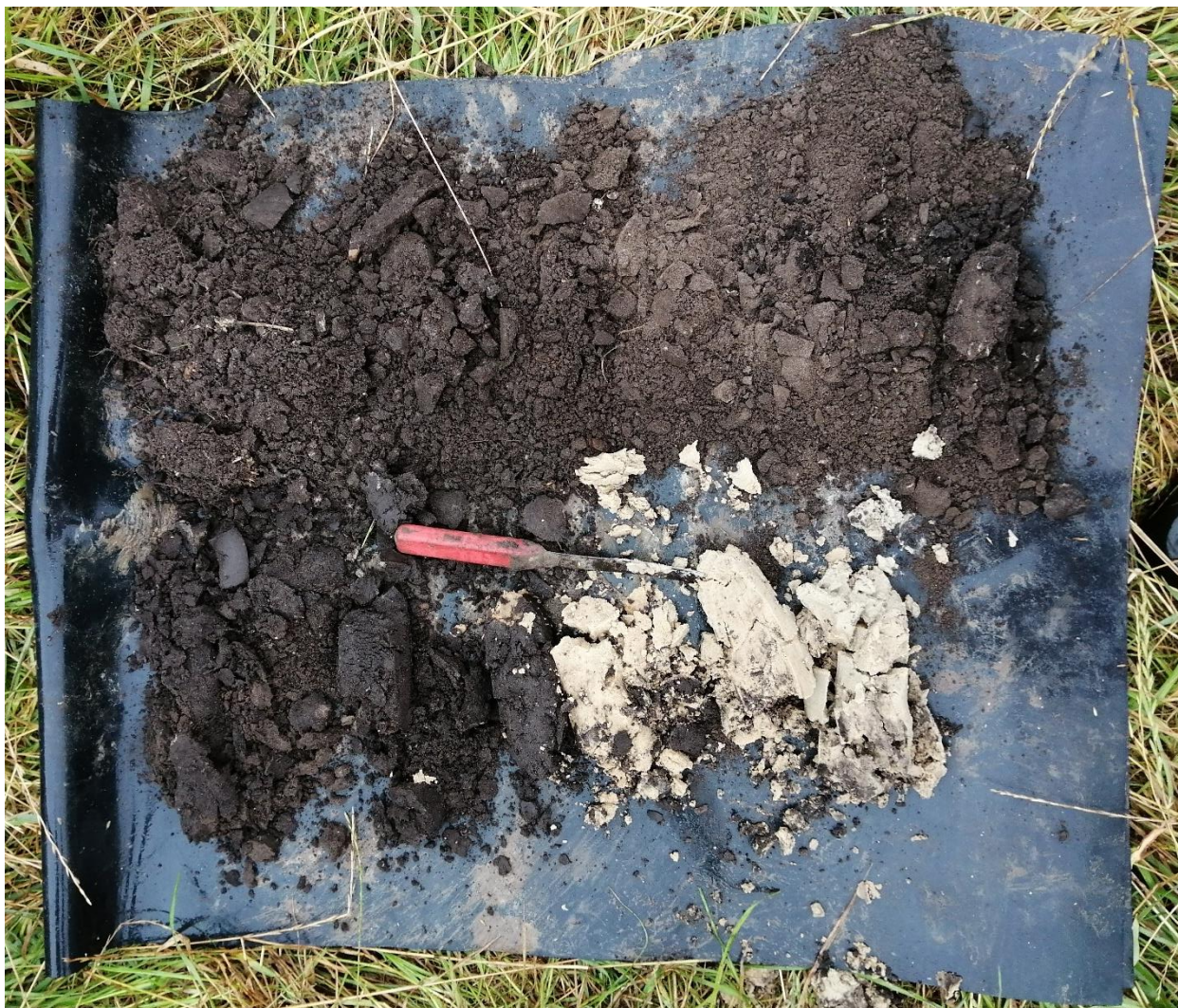
Afb. 14. Foto boring 3, met de humeuze slootvulling op het bleke dekzand
