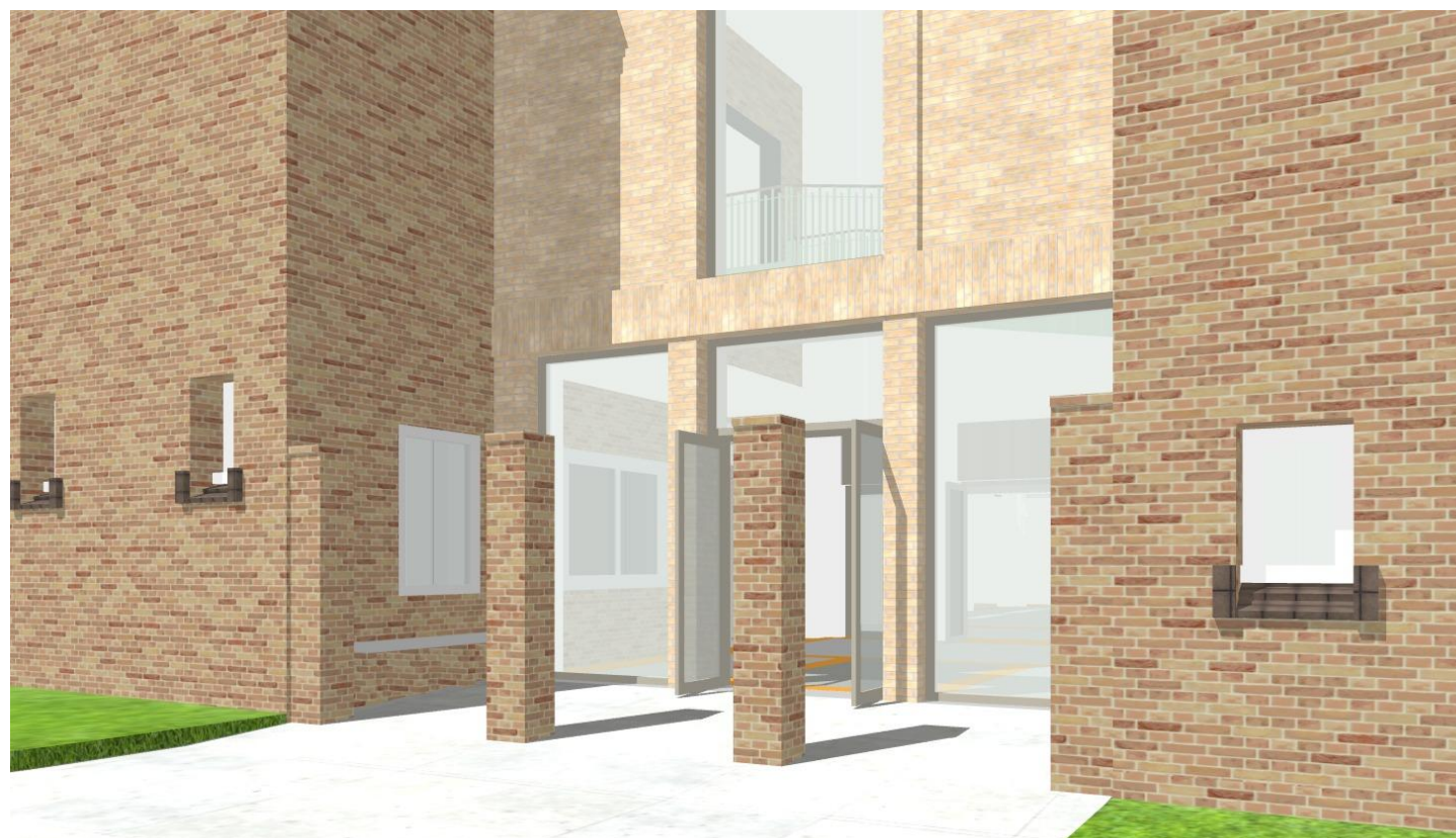
Penanten laten staan, hekwerk verwijderen
