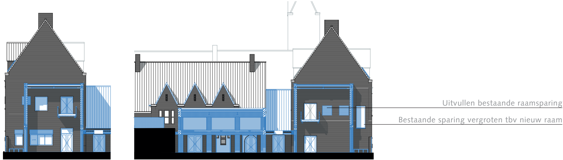
Nieuwe aanvulling/ sparingen in het bestaande metselwerk aangegeven
