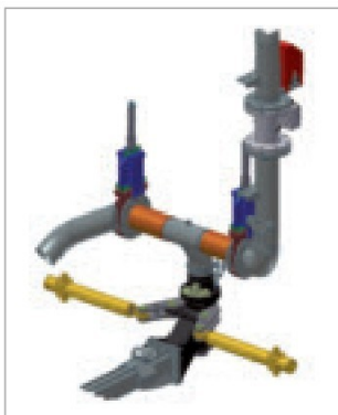
3D overzicht van de draaiconstructie van de hydrotelescoop, zoals toegepast in de nieuwe Spider hefmast.
