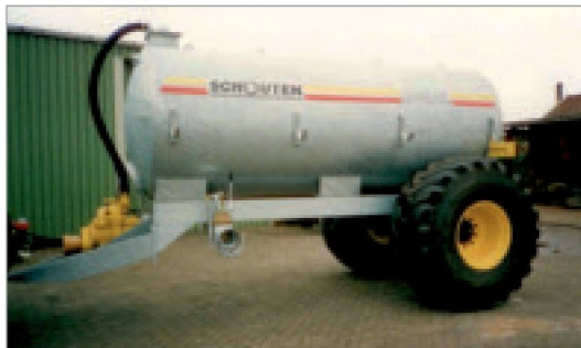
De eerste Ideal mesttankwagen op zijn wielen. Een VT80 inhoud van circa 8200 liter op banden, 28,1 R26 met 8.000 liter vacuümpomp. The first Ideal slurry tanker on its wheels. A VT80 with a capacity of approx. 8200 L on wheels, 28.1 R26 with a 8,000 L vacuüm pump.
