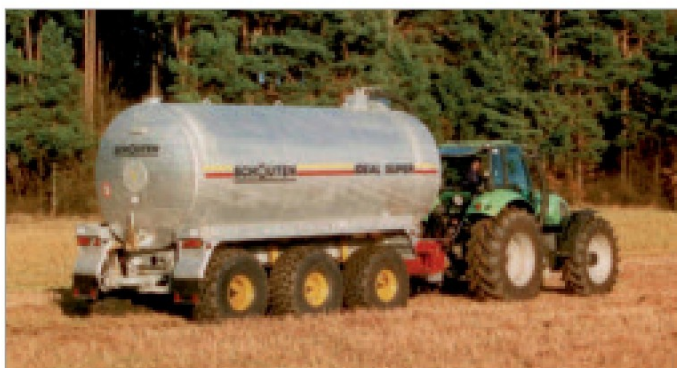
De allergrootste Ideal Super tankwagen. Hier het model VTS260, 26.500 liter tankinhoud op tridem onderstel met hydro pneumatische vering en uitgerust met waterringpomp. Geleverd aan Firma Becker Hopf in Lohra Willershausen (Hessen Duitsland). The largest Ideal Super tanker. Here the model VTS260, 26,500 L tank capacity with a tridem carriage with hydro-pneumatic suspension and a water ring pump. Delivered at the Becker Hopf company in Lohra Willershausen (Hessen, Germany).
