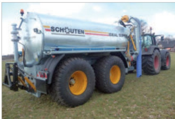
De Ideal XL tankwagen model VTS 160 uitgerust met een zuigarm van 250 mm met een daarin geïntegreerd de Turbomaster turbopomp.
