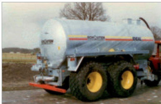
Uitbreiding en completering van de Ideal serie mesttankwagens. Boven afgebeeld; een VTS150 tankinhoud 15.000 liter op tandemonderstel met Buggy vering en gestuurde achteras. Expansion and completion of the Ideal series slurry tankers. Above a VTS150 is shown with a tank capacity of 15,000 L on a tandem with Buggy suspension and steered rear axle.
