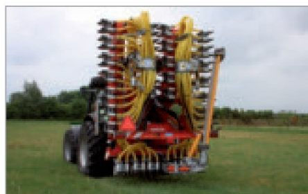
De Spider in opgeklapte positie voor transport over de weg. The Spider in folded position for transport over the road.
