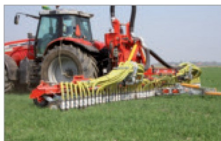
De Spider aangebouwd aan de trekker in werk- positie met aangekoppelde sleepslang. The Spider built onto a trekker in work position with the attached slurry hose.
