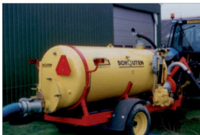
De PW30 pompwagen met centrifugaalpomp tbv het mest verpompen bij het sleepslangstelsel. The PW30 pump wagon with centrifugal pump for pumping slurry into the drag hose slurry system.
