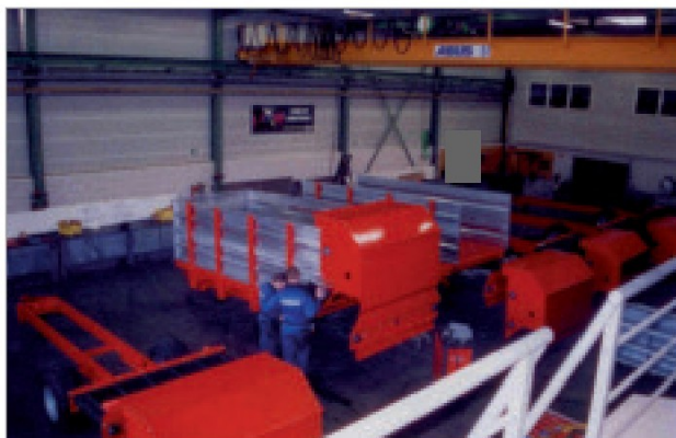
Seriematige montage van de Quickfeed voerdoseerwagens. Assembly of the Quickfeed feeding wagons.
