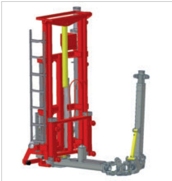
Een samenstelling van een 3 dimensionaal ontwerp van de Hydro-hefmast tbv de Sprinter sleepslangbemester. A composition of a 3 dimensional design of the Hydro-lift for the Sprinter drag hose slurry injector.
