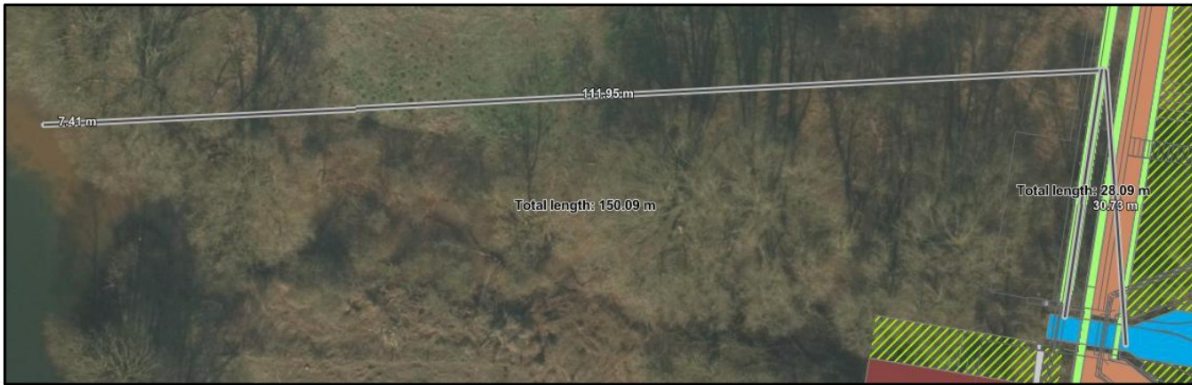
Figuur 7 In- en uittredepunt en kwelweglengte – Noordzijde; diepe kleilaag
