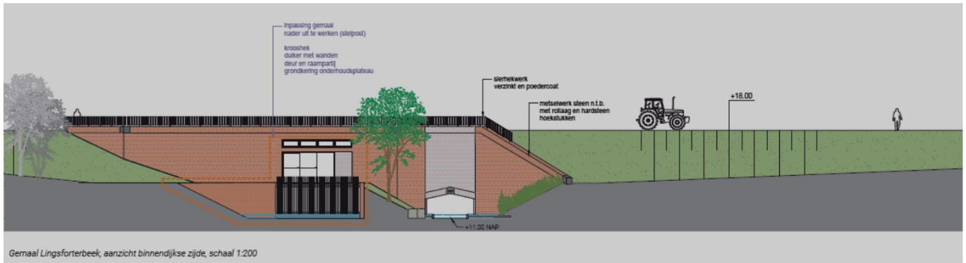
Visualisatie Gemaal Lingsforterbeek, aanzicht binnendijkse zijde, schaal 1:200 – vanuit oostelijke richting
