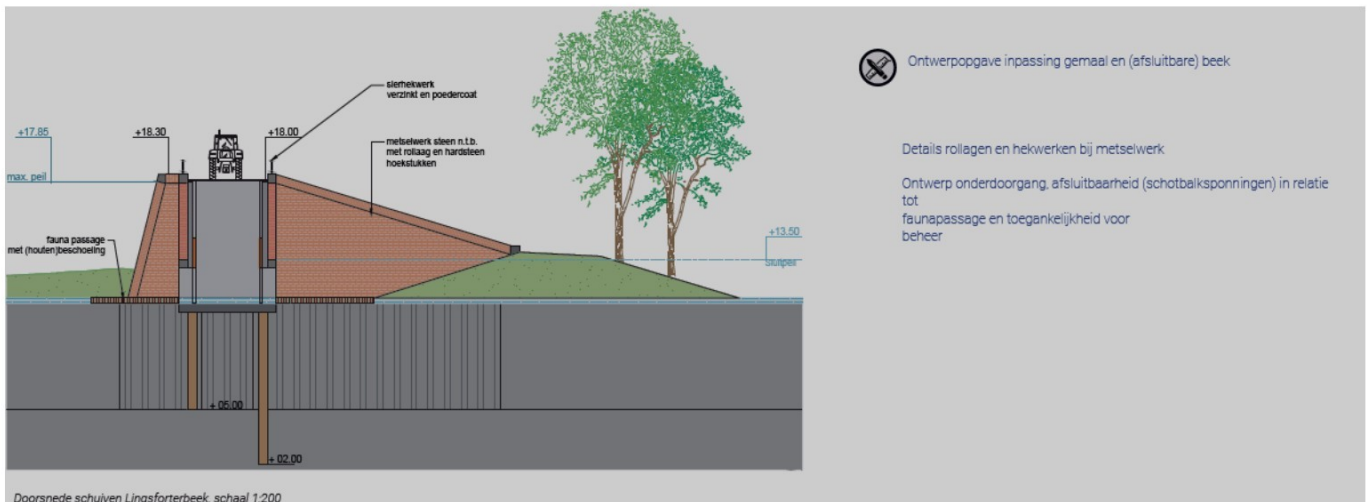
Visualisatie doorsnede schuiven Lingsforterbeek – gezien vanuit zuidelijke richting
