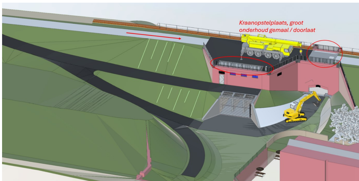
Figuur 7.1: Locatie kraanopstelplaats en de hijsluiken die staan aangegeven met de rode cirkels. Het noodstroomaggregaat bevindt zich aan de zuidkant achter de kraan.
