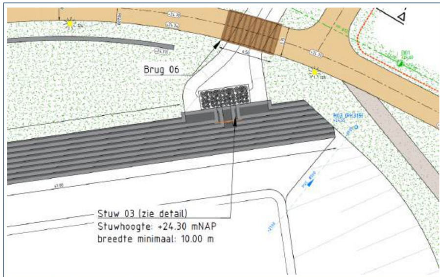
Afbeelding 15 – Detail stuw S03
