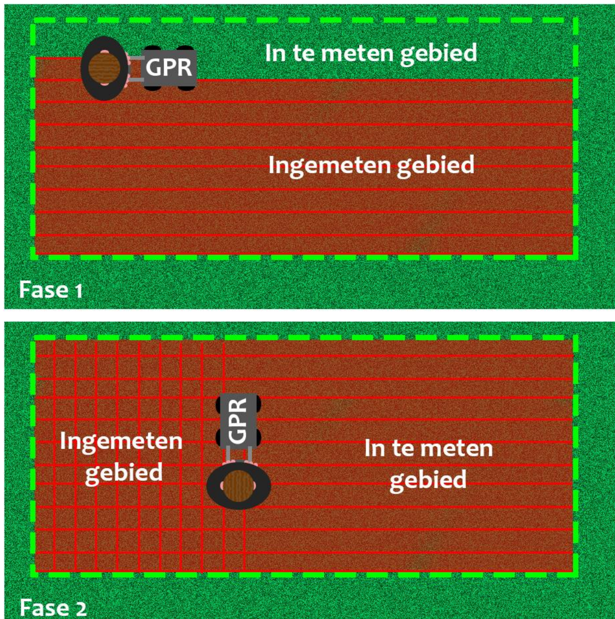
Figuur 45. Schematische weergave van het principe 'vlakdekkend inmeten middels grondradar'. Bron afbeelding: BeoBOM.
