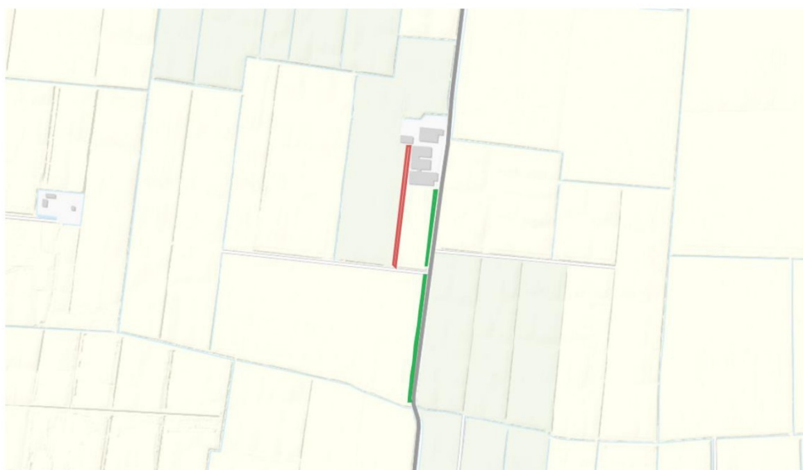
Figuur 1: Locatie activiteiten. Het rode vlak geeft het te dempen oppervlaktewaterlichaam weer. Het groene vlak geeft het te verbreden oppervlaktewaterlichaam weer.
