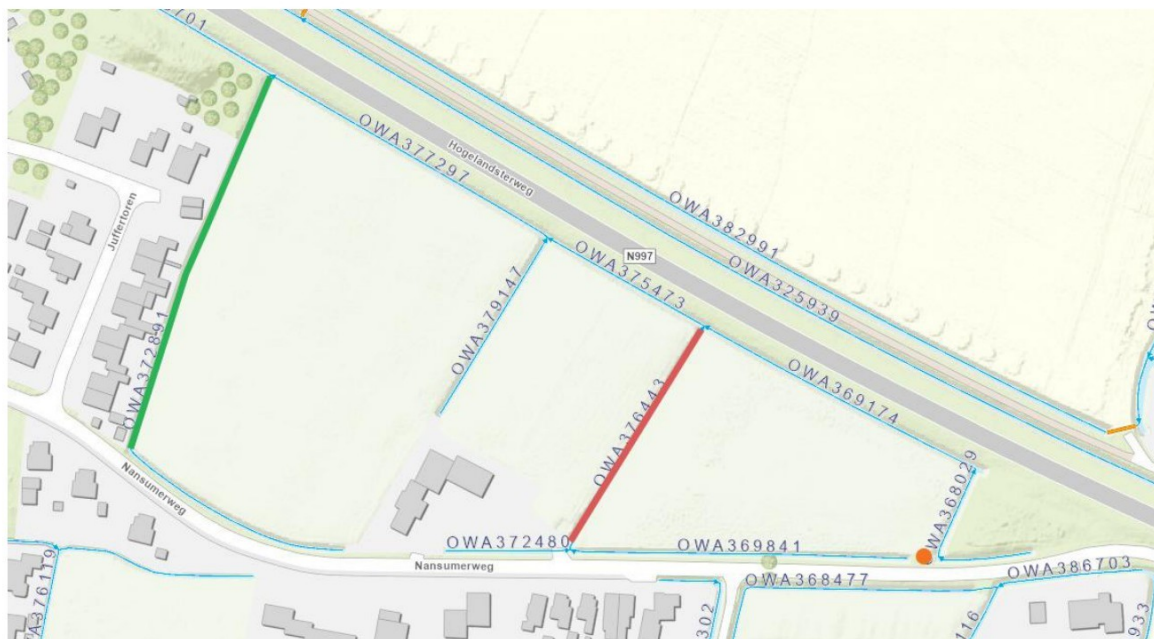
Figuur 1: Situatietekening. De rode lijn geeft globaal de locatie weer van de te dempen watergang. De groene lijn geeft globaal de locatie weer van de te verbreden watergang. De oranje stip geeft globaal de locatie van de aan te leggen duiker weer.
