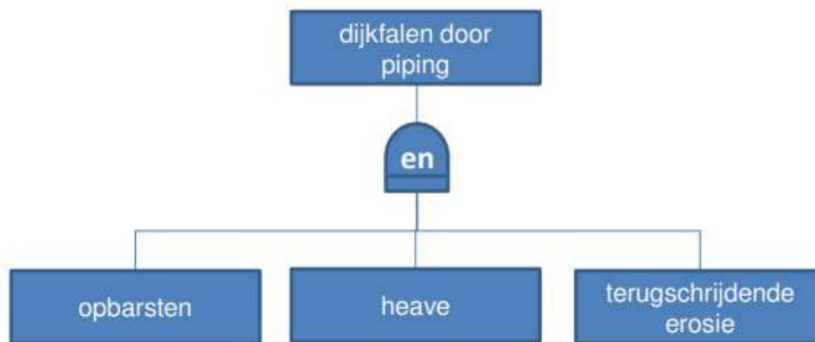
Figuur 4-2 Foutenboom beoordeling op piping en heave (RWS, 2017).
