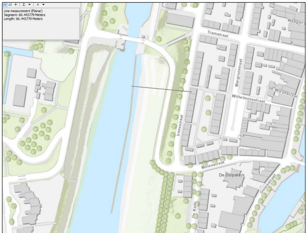
Figuur 2-28: Kwelweglengte vanuit Merwedekanaal naar bebouwing met laagste souterrainniveau.
