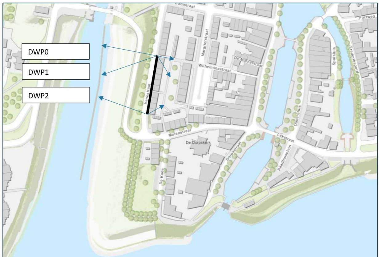
Figuur 4-5: Ligging dwarsprofielen t.b.v beoordeling STPH in bouwfase archeologie. Te zien is dat door de ligging van de damwand de ligging van de profielen worden bepaald door achterloopsheid.
