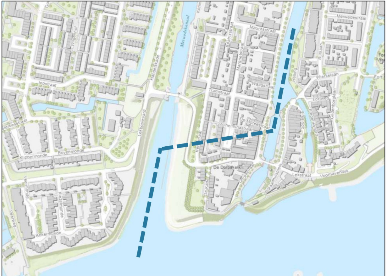
Figuur 7-2: Ligging dwarsprofiel dat zowel haaks op de dijk staat als rekening houdt met de richting van de grondwaterstroming.
