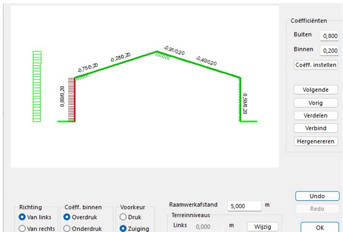
Figuur 14 Drukcoëfficiënten zuiging buiten + overdruk binnen
