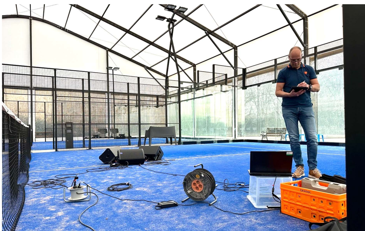
Figuur 3 Geluidsmeting uitgevoerd door 5.1.2e
