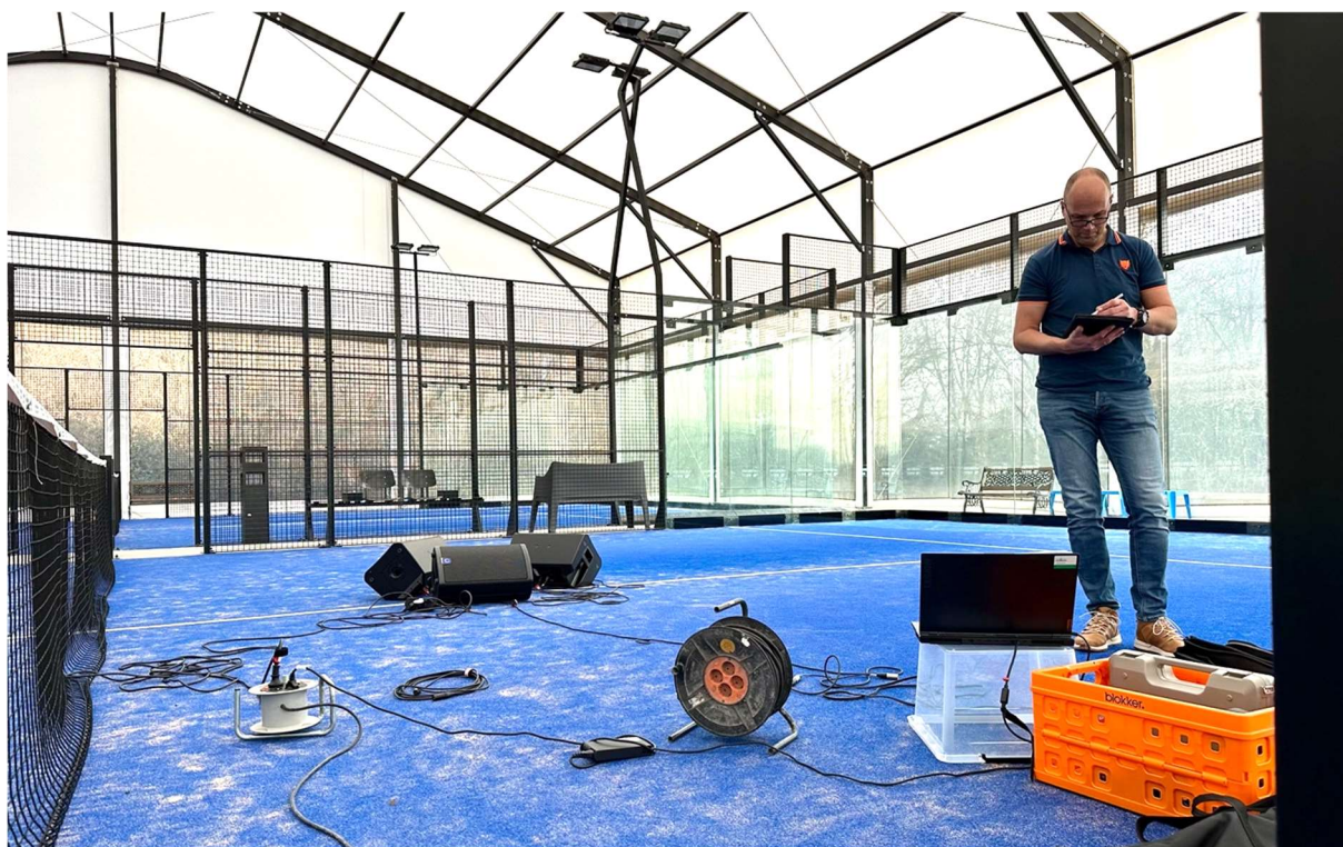
Figuur 3 Geluidsmeting uitgevoerd door 5.1.2e
