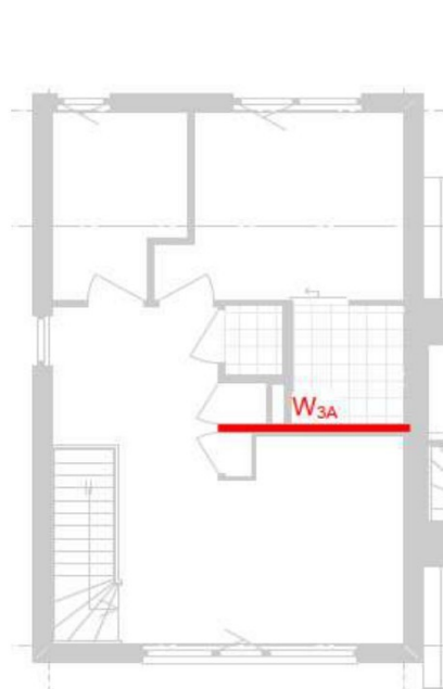
figuur: stabiliteitswanden 2e verdieping
