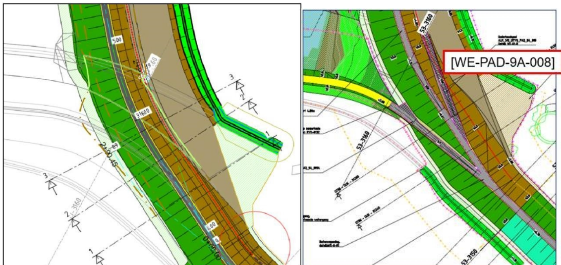
Figuur 2-14 Bovenaanzicht dijkopgang [WE-PAD-9A-008] met dwarsprofielen
