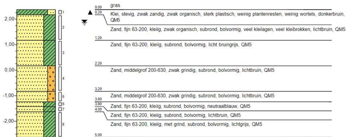
Figuur 2-18 Grondopbouw bestaande uiterwaard - ter plaatse van de bestaande graslanden (IB-PP-01-03) [Ref. 14]
