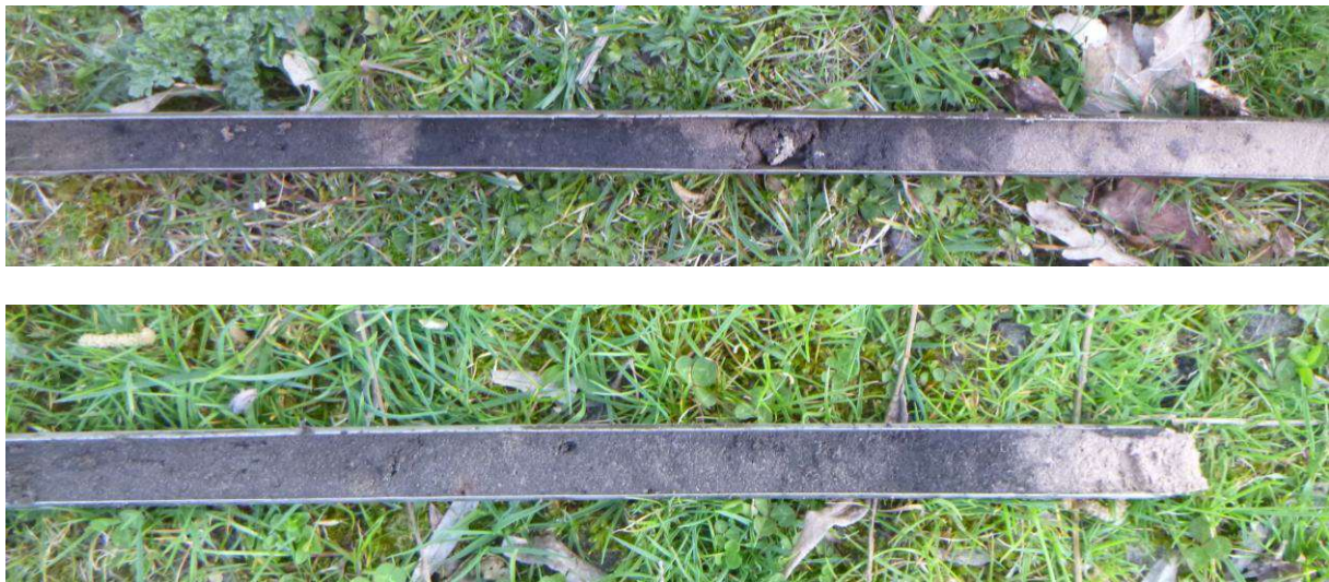
Figuur 24: De bodemopbouw op de boorpunten 1 en 11 met links de toplaag van humusrijk zand, en respectievelijk in het midden en rechts van het midden het moerige zand met geheel rechts het geelgrijze zand van de C-horizont.
