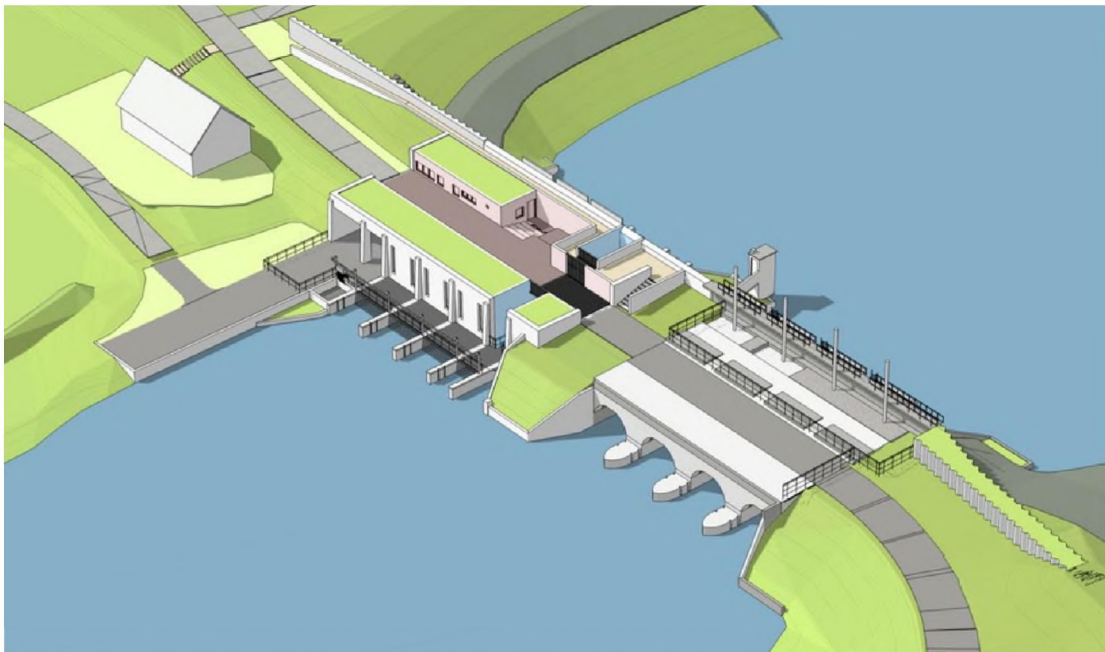
Figuur 2.10 Schematische weergave beoogde ontwikkeling (gemaal inclusief vispassage links, spuisluis rechts)
