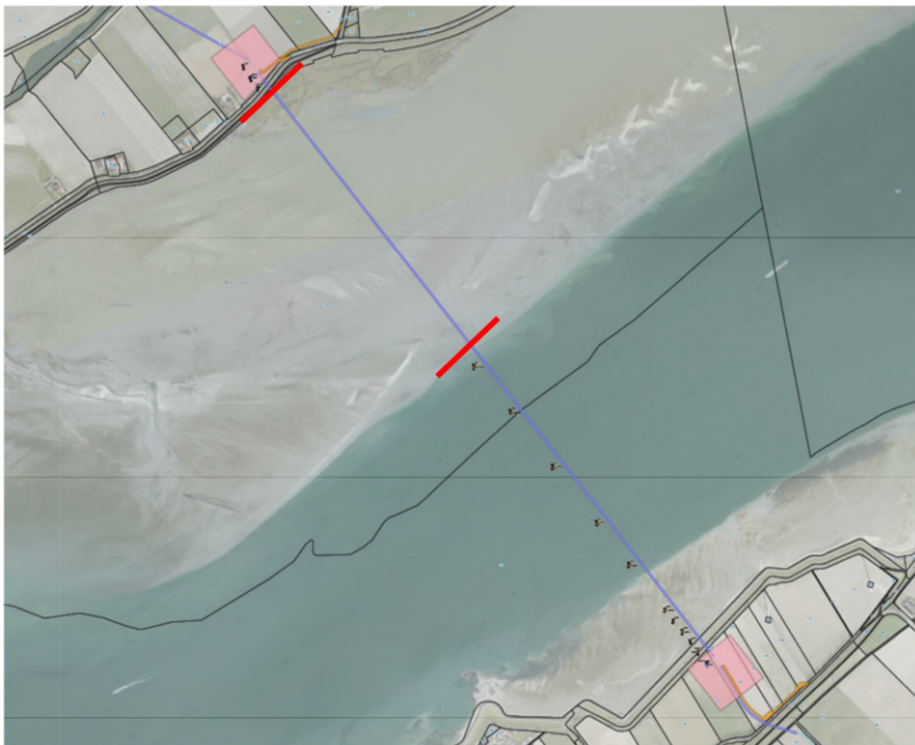
Figuur 2. Detail overzicht van de locaties waar de boringen en sonderingen plaatsvinden. Op het schor en de slikken, gelegen ten noorden van de vaargeul worden geen boringen of sonderingen of andere werkzaamheden uitgevoerd.
