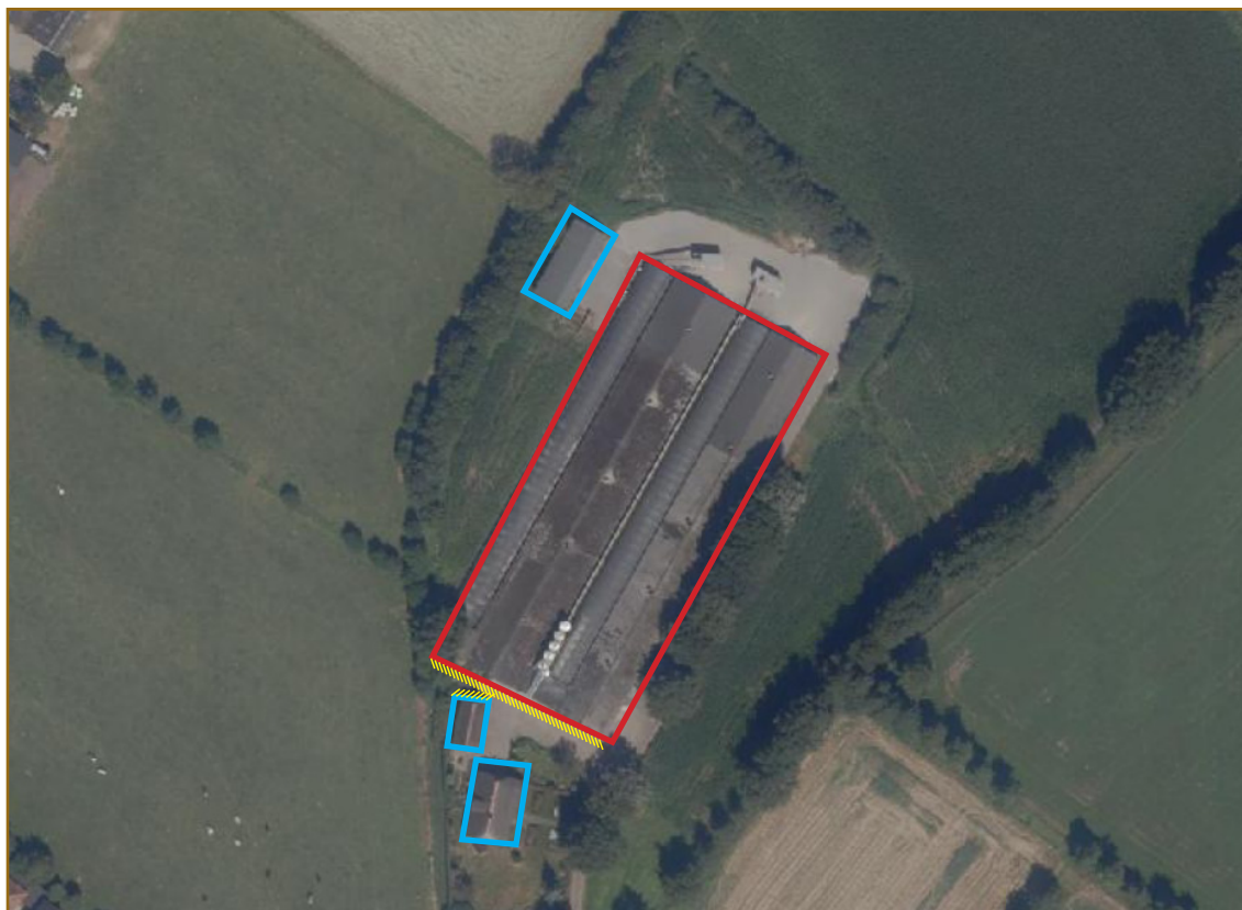
Afbeelding 1.1: Luchtfoto van het plangebied met de te slopen bebouwing (rood omlijnd) en te behouden bebouwing (blauw omlijnd) en gele lijn zijn gevels met geschikte openingen. Bron ondergrond: PDOK viewer Luchtfoto.
