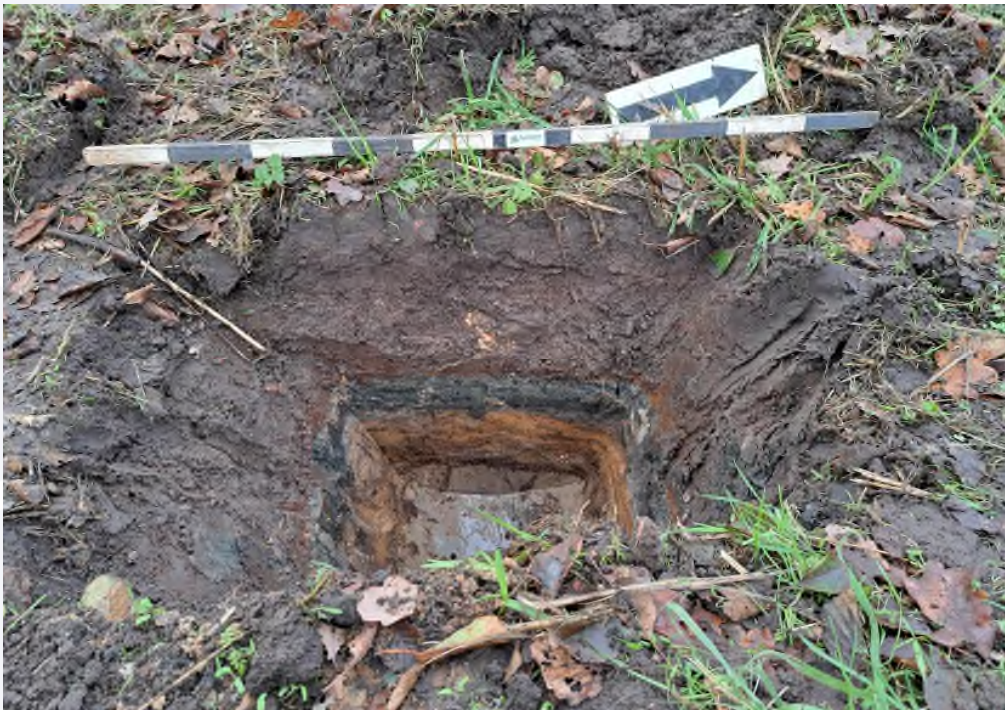
Afbeelding 12: profielkuil gegraven ter plaatse van boorpunt 25 met de bodemopbouw (van boven naar beneden): AP-horizont (bouwvoor), verspoeld dekzand met humeuze lagen en een afdekkende grijze lemige laag, C-horizont (dekzand). Foto genomen door de auteur.
