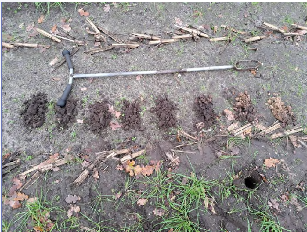
Afbeelding 10: boorprofiel van boring 04 met de bodemopbouw (van links naar rechts): AP-horizont (bouwvoor), AP-horizont (esgrond), C-horizont (dekzand). Foto genomen door de auteur.
