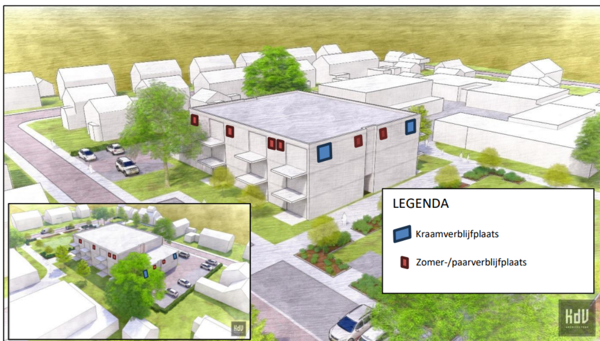
Figuur 4. Schetstekening met voorbeeld van de permanente voorzieningen.
