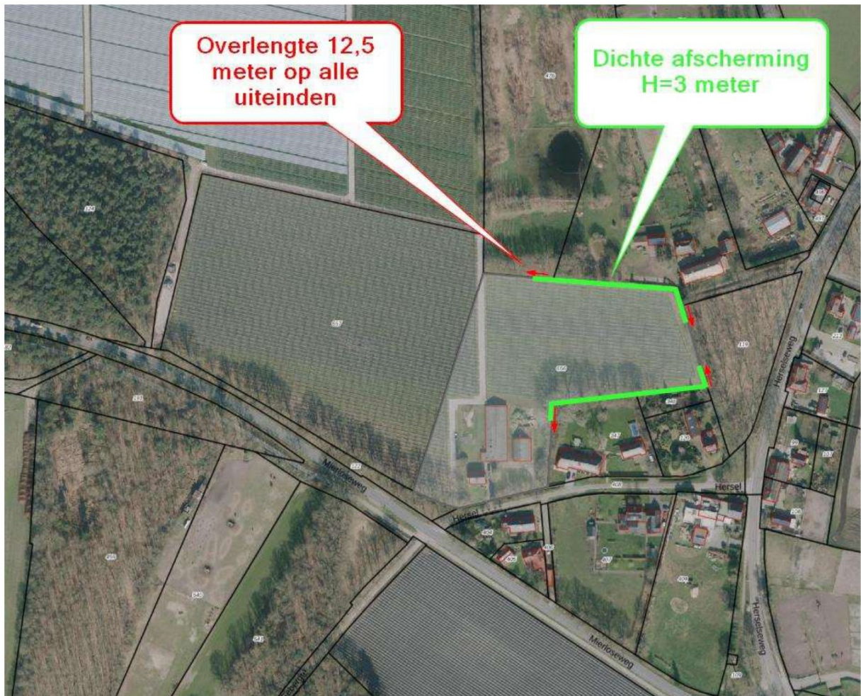
Afbeelding 10: overzicht geadviseerde minimaal vereiste afscherming (ondergrond: DSO)
