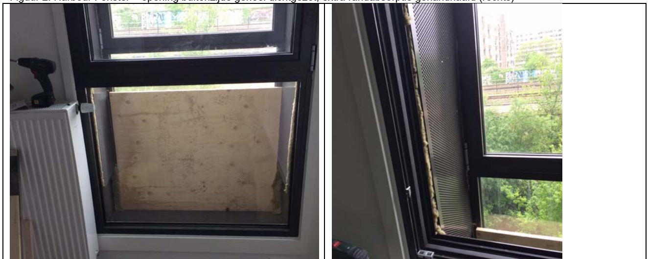
Figuur 2: Harbour Fenster – opening buitenzijde geheel dichtgezet, extra randabsorptie gehandhaafd (rechts)
