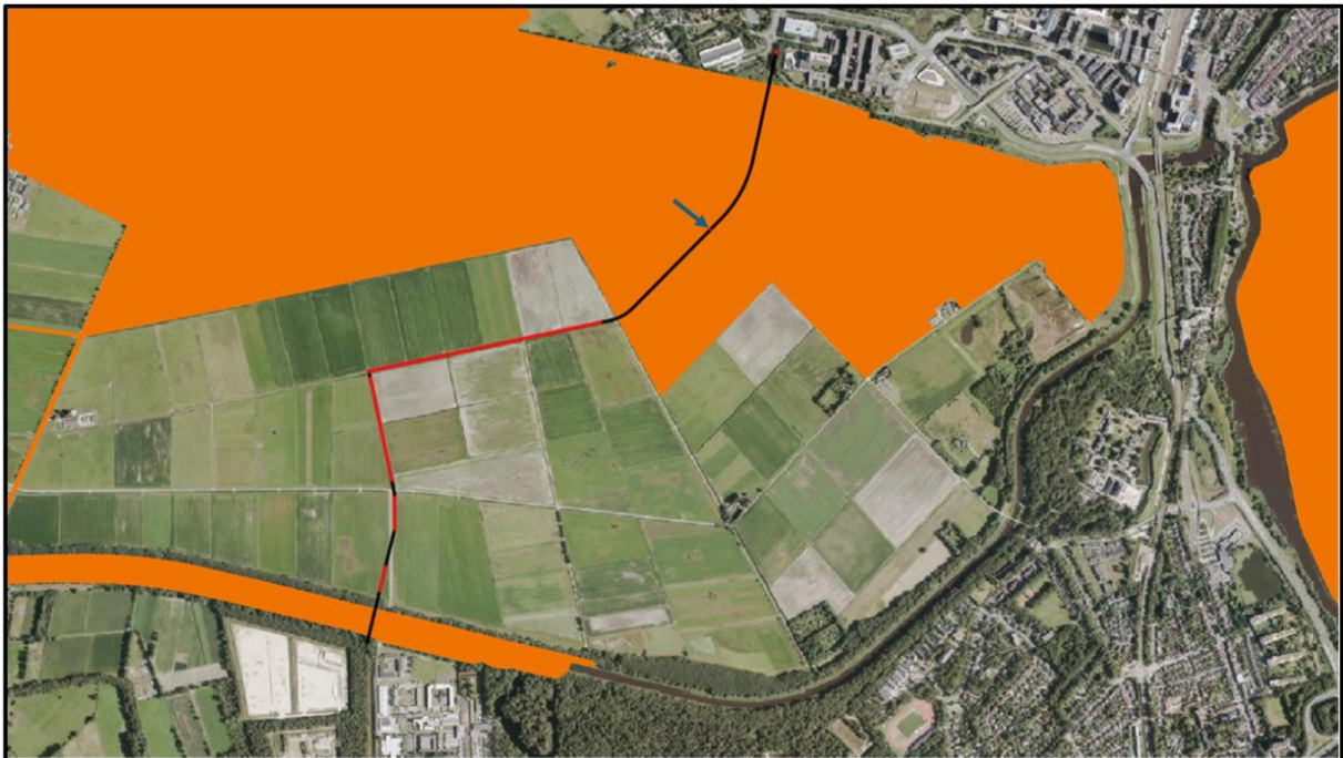
Figuur 3, Ligging fase 3. De rode lijn geeft de locaties van de open ontgravingen weer en zwarte lijn geeft de locaties van de gestuurde boringen weer. Bij de blauwe pijl vindt ook nog een open ontgraving plaats binnen het Natura 2000-gebied.
